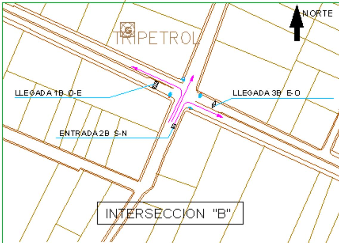
**Figura A.5:** *Movimientos Posibles para la Tercera Fase en la Intersección B*
