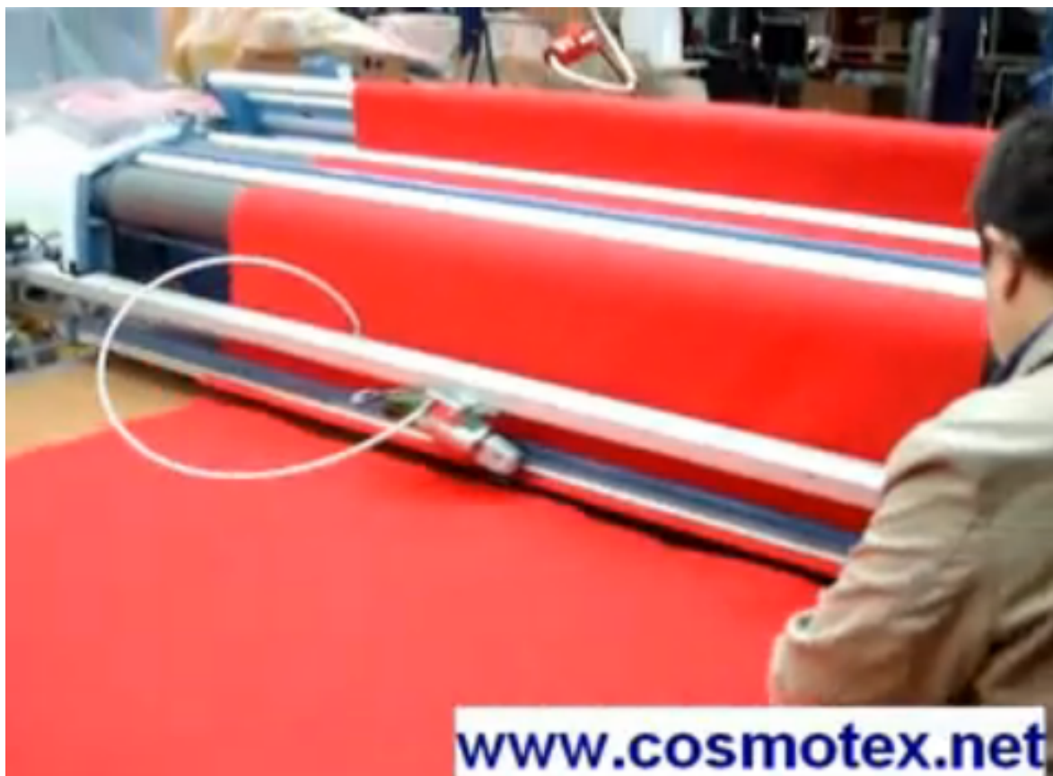
ILUSTRACIÓN 3.5: PROTOTIPO 2 – FUNCIONAMIENTO EXTENDEDORA COSMOTEX
