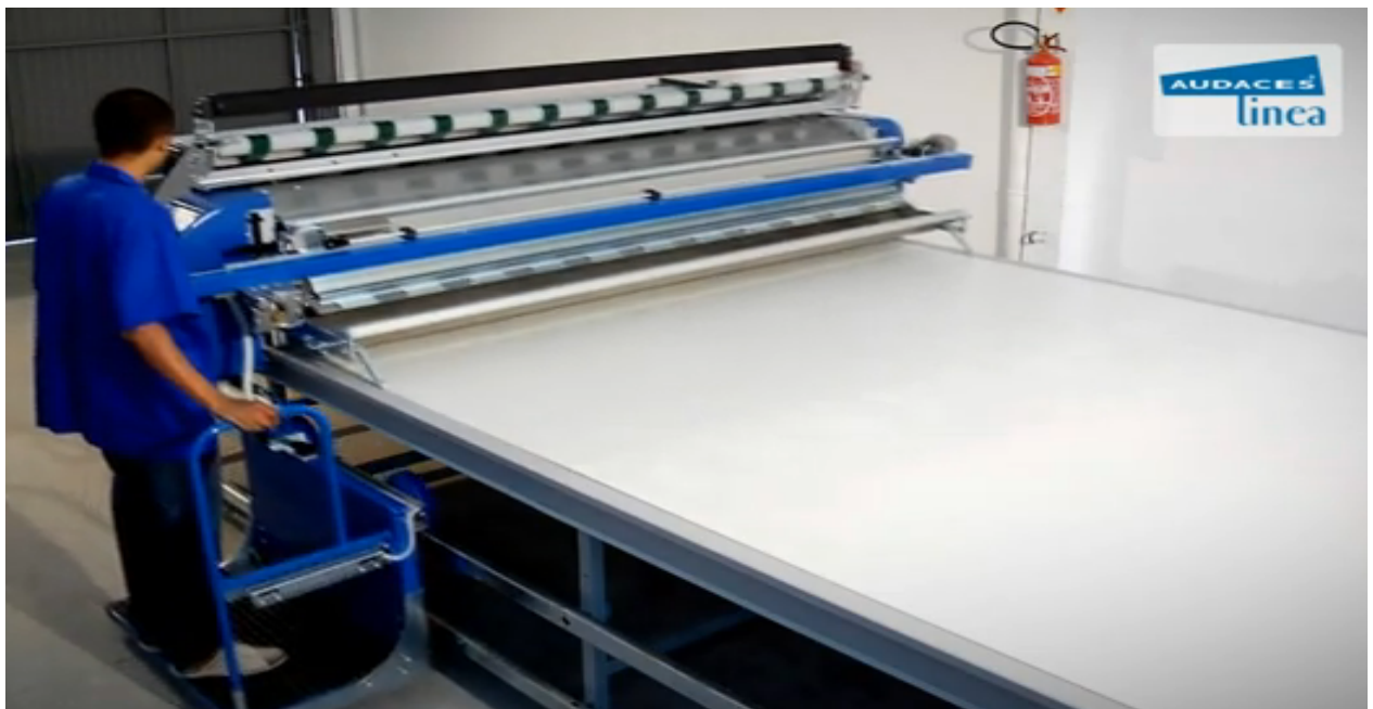
ILUSTRACIÓN 3.3: PROTOTIPO 1 – FUNCIONAMIENTO EXTENDEDORA AUDACES
