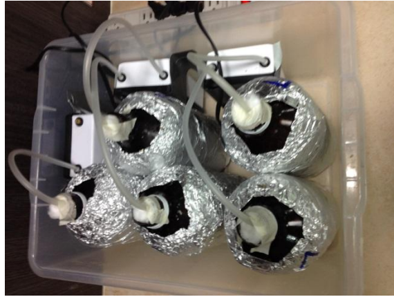
Ilustración 5 Montaje de los 5 reactores para estudio de aclimatación.
