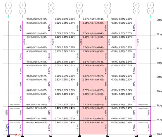
Figura 102. Vigas exteriores y columnas de exteriores y esquinas.
