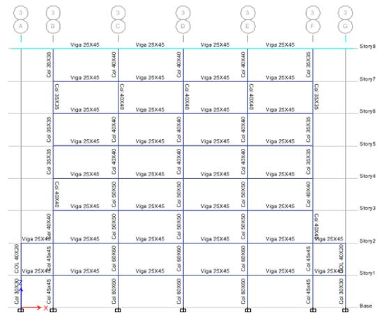
Figura 101. Secciones transversales
