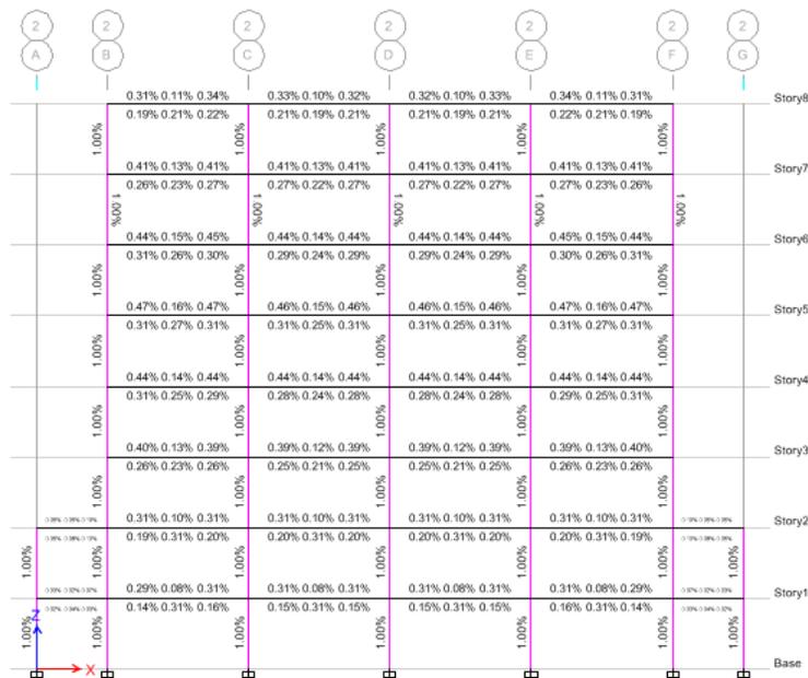
Figura 22. Vigas exteriores y columnas de exteriores y esquinas.
