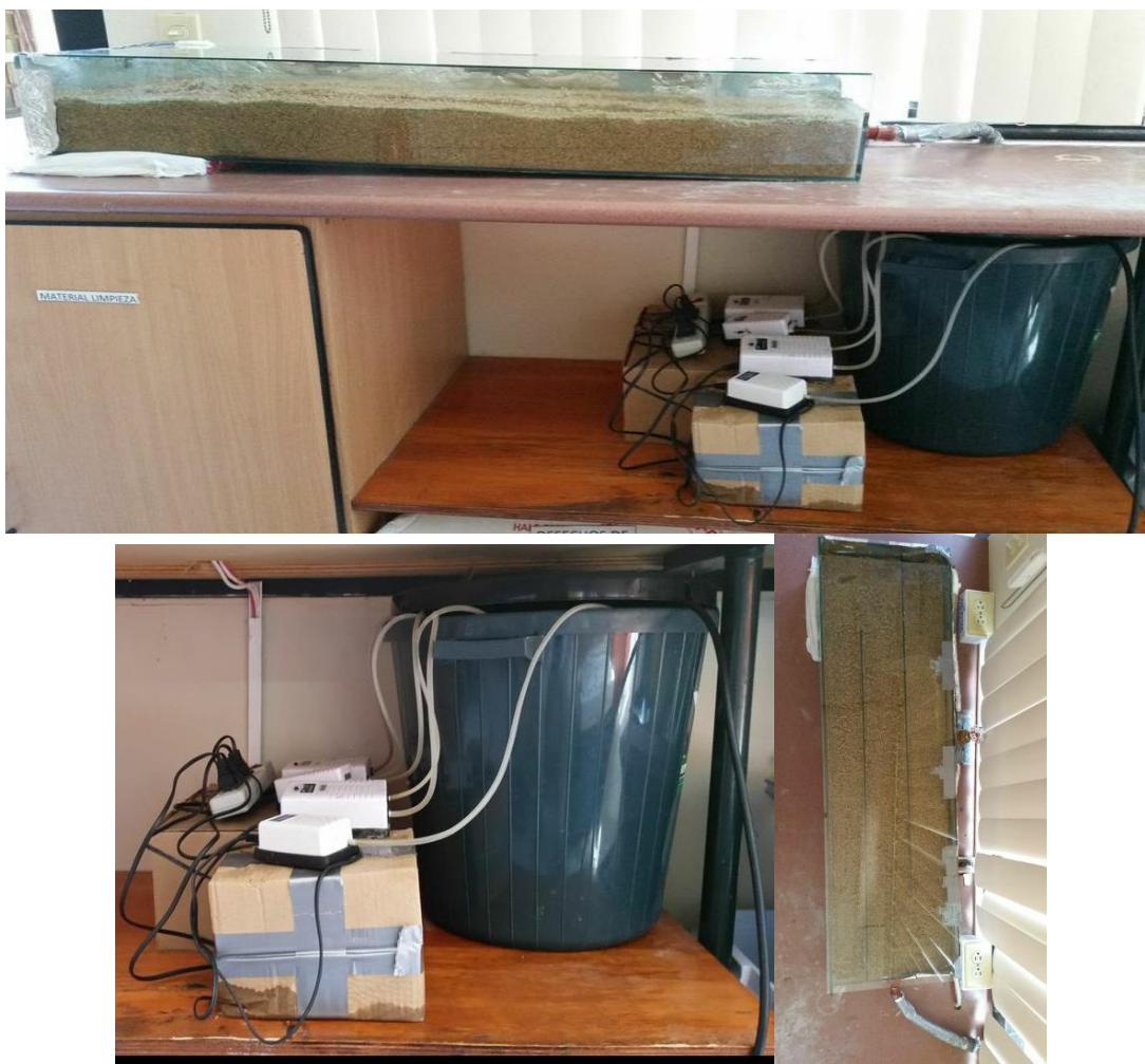
Anexo 4. Bioreactor a escala laboratorio (filtro de arena, tanque de alimentación y bombas aireadoras)
