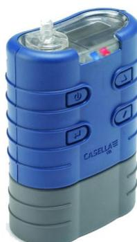
**Figura 3. Bomba portátil de muestreo personal**
