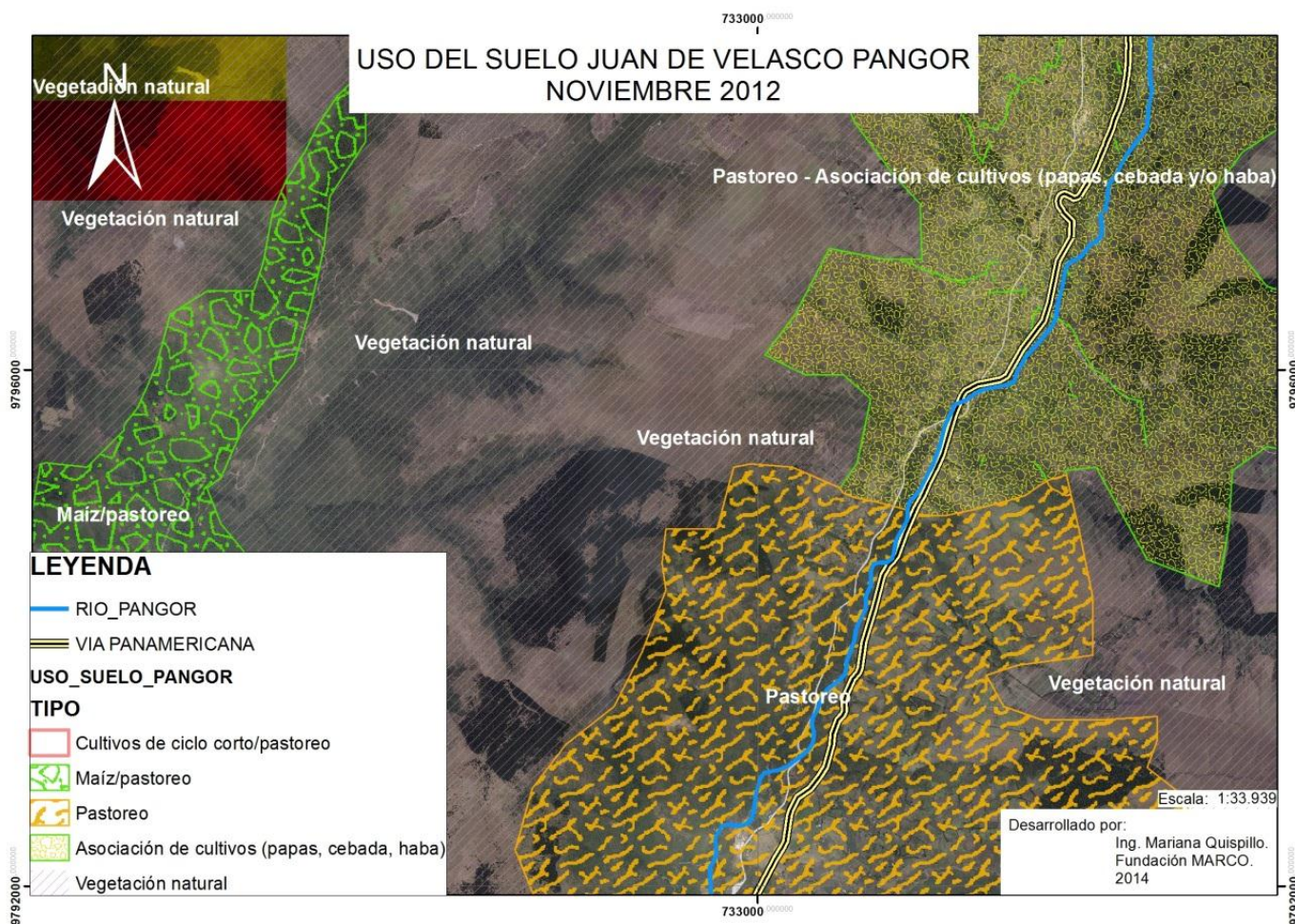
FIG.11 - Superposición Ortofoto zona y capa uso suelos Fuente: Programa SIG Tierras. MAGAP (Ortofotos), Levantamiento geográfico in situ
