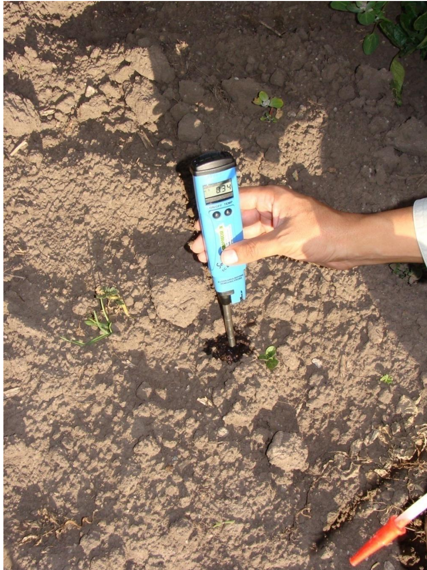
Figura 37. Humedecimiento del suelo con agua destilada y lectura con sensor.
