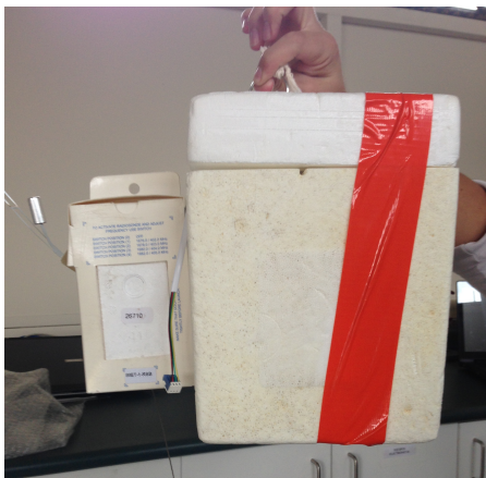
Figura 8. Preparación de radiosonda y ozonosonda para el lanzamiento
