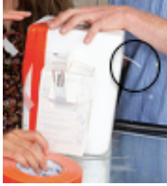
Figura 10. Colocación del tubo de entrada de la ozonosonda para sondeo de aire atmosférico
