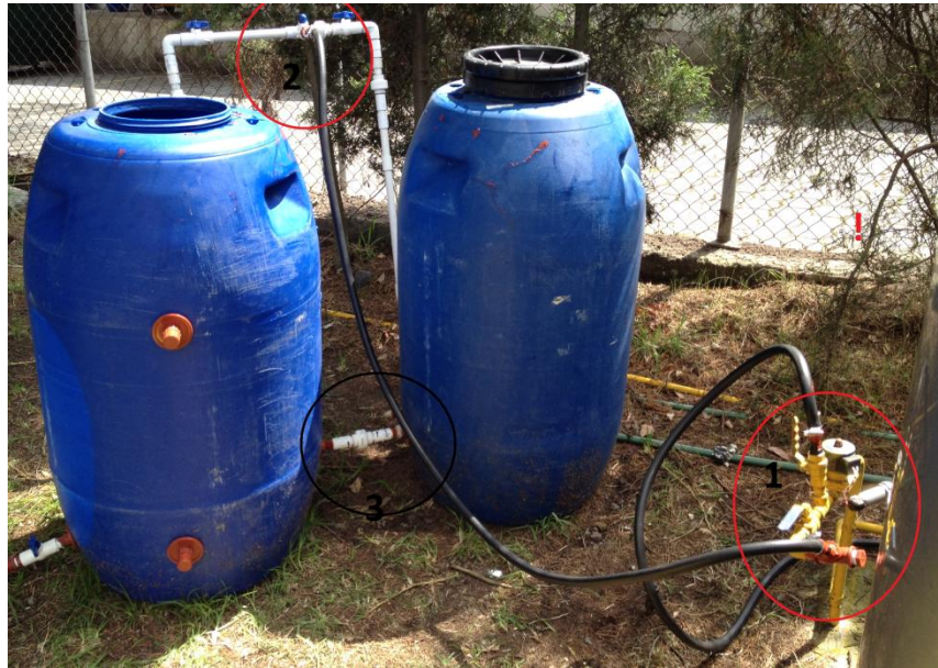
Figura 4.10: Sistema de recolección temporal de biogás
