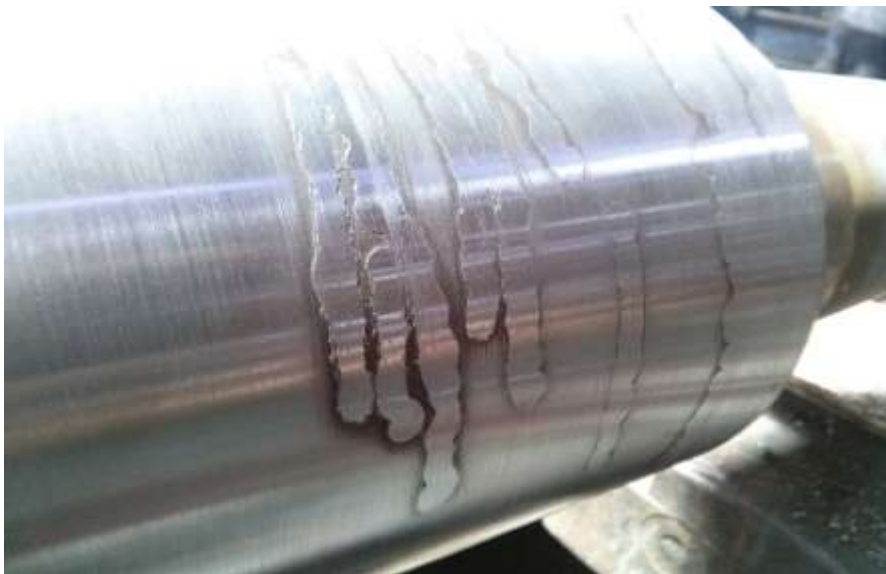
Figura 41 Rodillo d=5 15/16 con soldadura en la superficie
