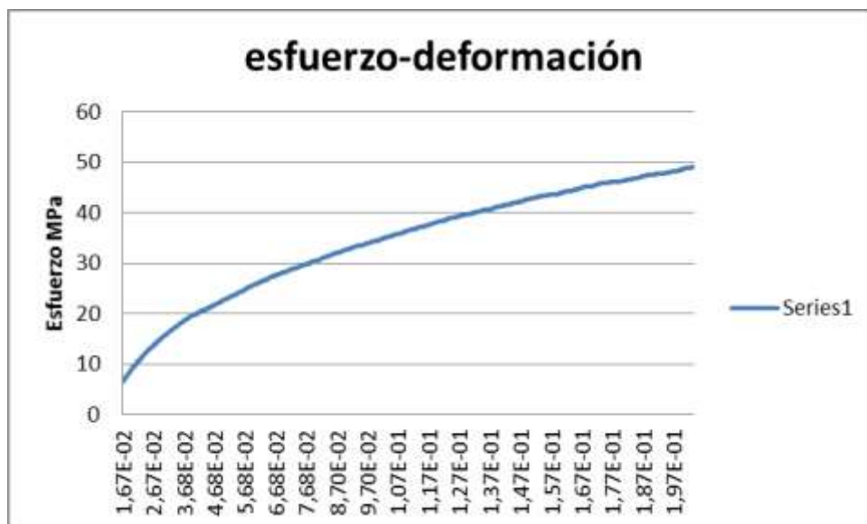
Figura 9 Diagrama esfuerzo-deformación de la banda de lija
