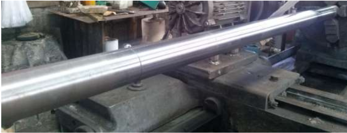
Figura 37 Eje de prueba segmentado con distintos terminados superficiales
