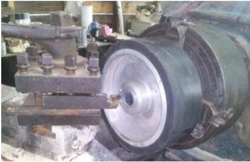
Figura 23 Maquinado polea 180mm.
