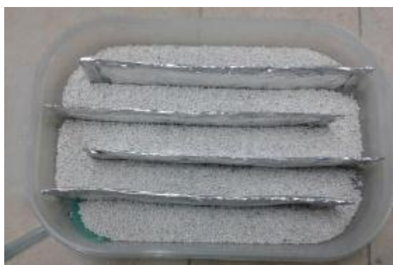
Figura 5 Reactor PFR con TiO 2 fijado a arena (Alarcón, 2014)
