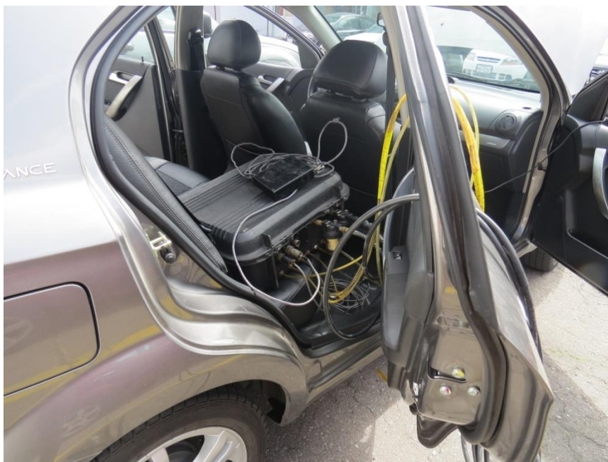
Figura 6: Analizador de gases Instalado en el vehículo de prueba
