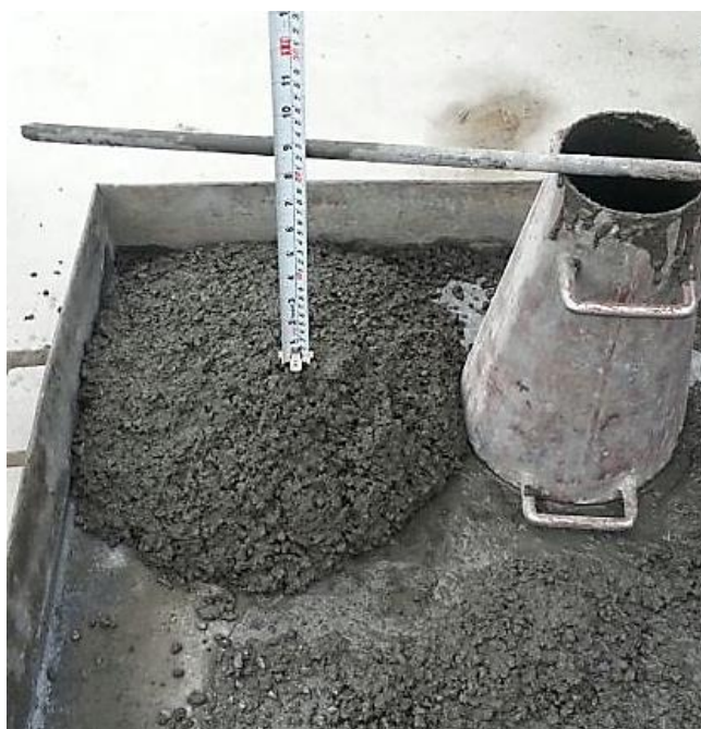
Figura 22: Revenimiento típico en muestras de la mezcla 4.
