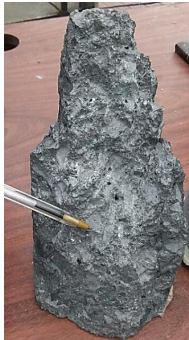
Figura 23: Superficie de fallo de cilindro de prueba a compresión (mezcla 4).
