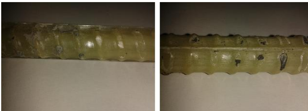
Figura 35: Superficie de la varilla “Marshall Industries C-Bar” posterior a la falla.
