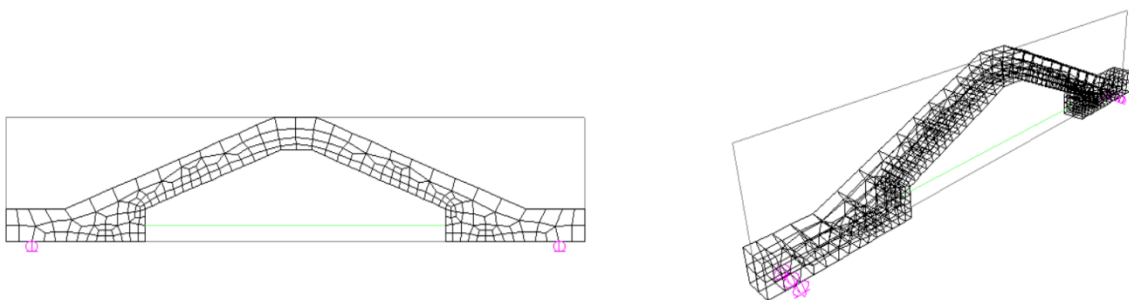
Figura 38: Modelo computacional de la estructura tipo viga.
