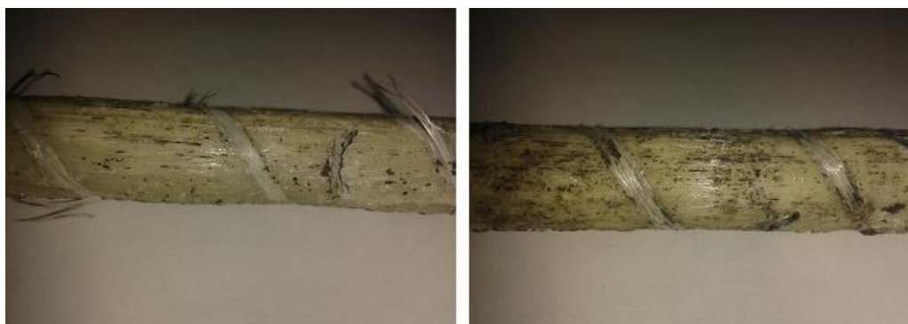
Figura 36: Superficie de la varilla “Hughes Brothers Aslan” posterior a la falla.
