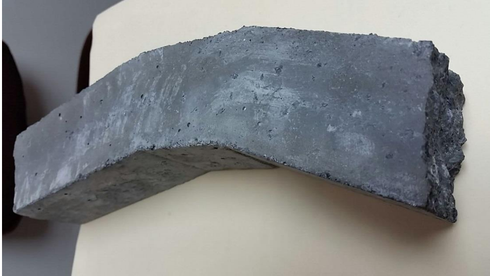
Figura 37: Falla a cortante.
