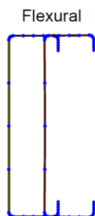
Figura 4. Gráfico de la deformación de la sección transversal por pandeo global debido a flexión. Fuente: DSM Manual 2006
