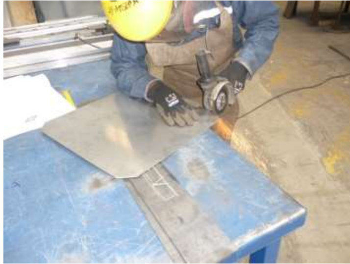
Figura 4.3: Corte de las piezas con moladora
