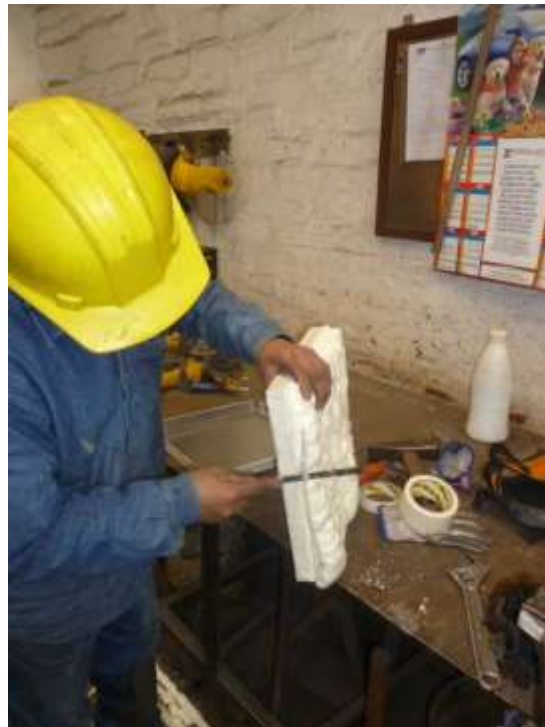
Figura 4.15: Corte de exceso del poliuretano.
