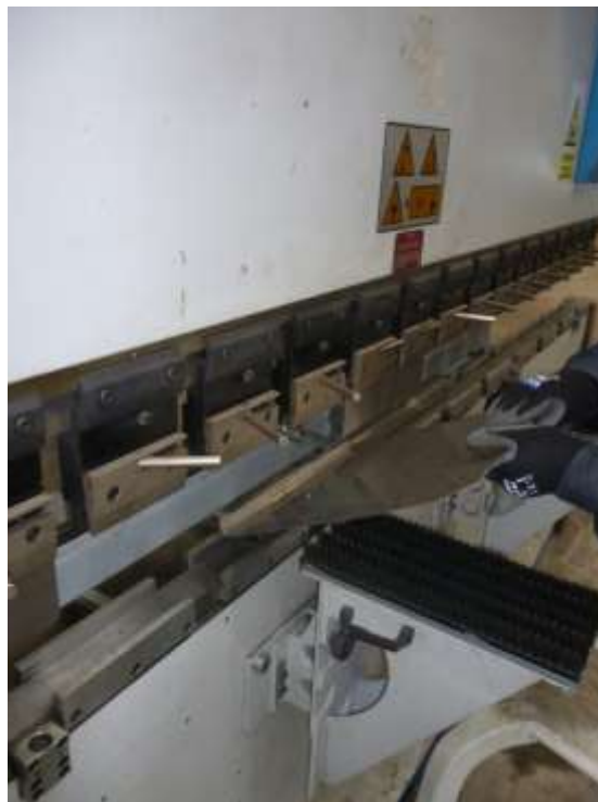
Figura 4.5: Doblado de las piezas en la dobladora industrial
