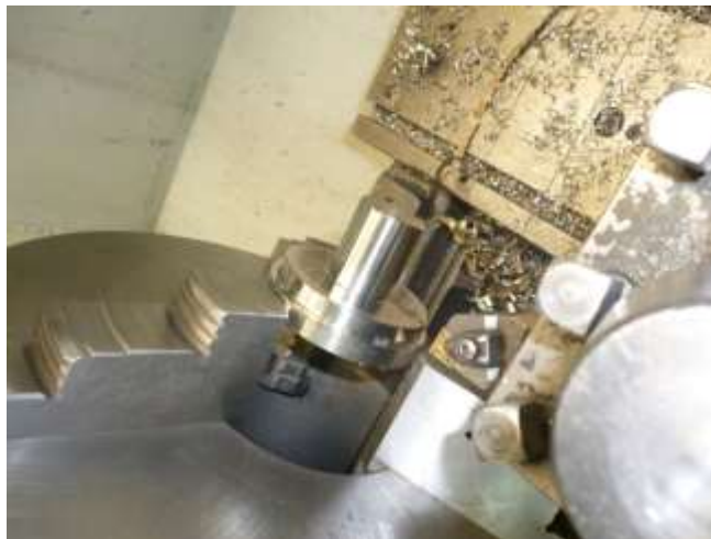
Figura 4.17: Torneado de bridas
