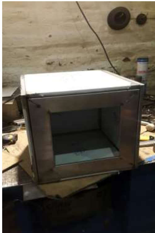
Figura 4.20: Estructura de incubadora soldada
