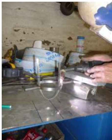
Figura 4.12: Suelda de canastillas con el eje.
