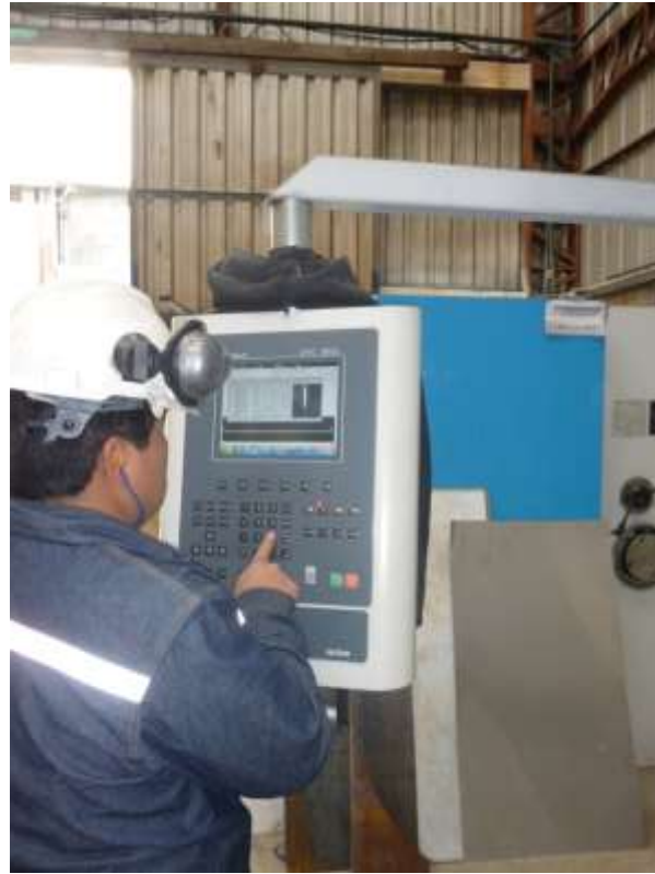
Figura 4.4: Configuración de la dobladora industrial
