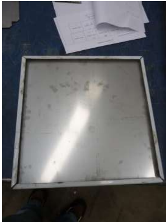
Figura 4.6: Pieza doblada o placa
