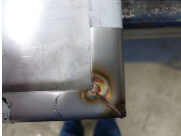
Figura 4.9: Suelda con puntos en las esquinas de las piezas
