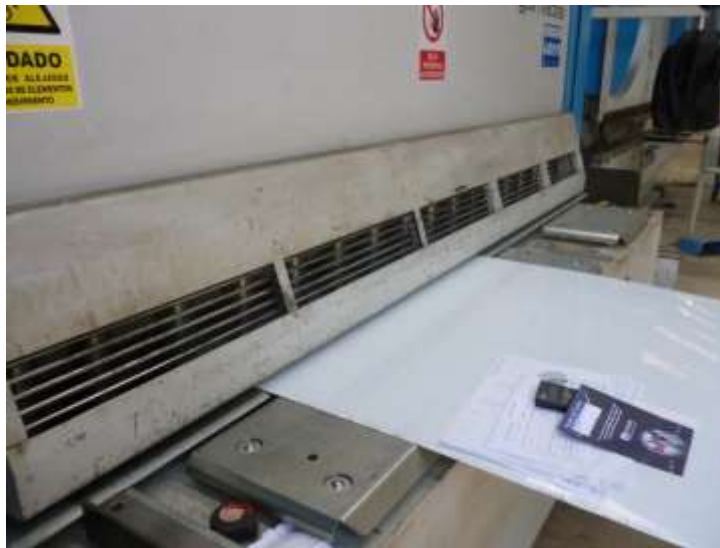
Figura 4.2: Corte de las piezas con la cortadora industrial
