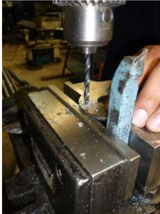
Figura 4.18: Fresado de bridas
