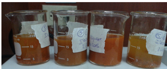
Figura 24: Colores finales de la solución de perclorato de cobre con ácido tritiocianúrico en los diferentes solventes y en relación molar 1:1
