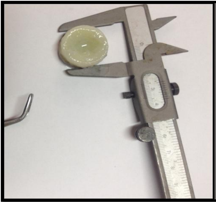
Figura 9. Calibrador en centímetros usado para medir D (diámetro) y r (radio) de la vértebra.
