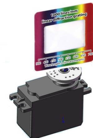
Figura 3-5: Red de difracción de 1000 líneas/mm sobre el servomotor Hitec HS – 311
