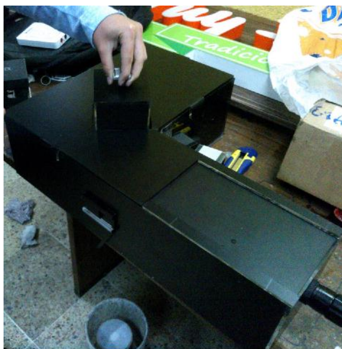
Figura 3-19: Vista lateral del espectrofluorímetro desarrollado
