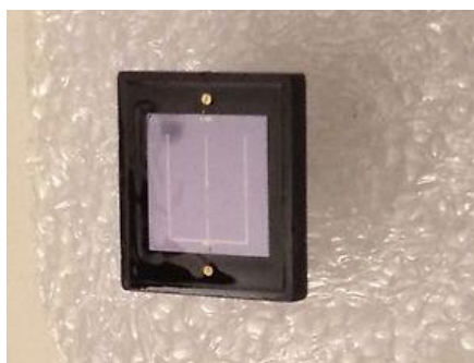
Figura 3-13: Fotodiodo de silicio modelo HS1010CE
