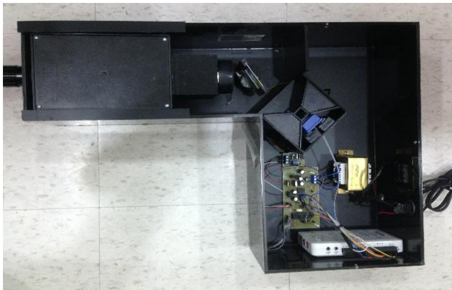
Figura 3-18: Vista superior del espectrofluorímetro desarrollado
