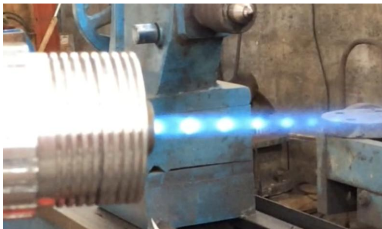
Figura 5.6 Diamante Supersónicos en Prueba T-2
