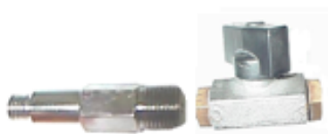
Figura 3.8 Inyector y Válvula de Alimentación de Polvos (T-10, T-12)
