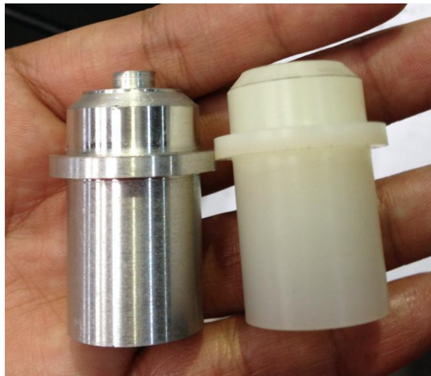
Figura 5.1 Pruebas CNC Tapa Cilíndrica de Aire (T-15)
