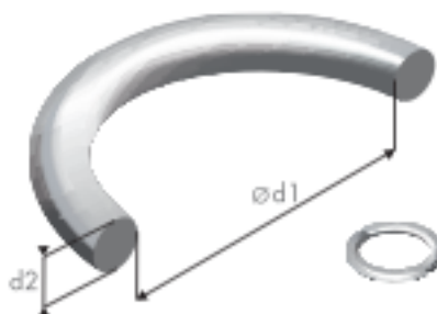
Figura 4.17 Selección de Sección Transversal de O-ring (NewDealSeals , 2008)
