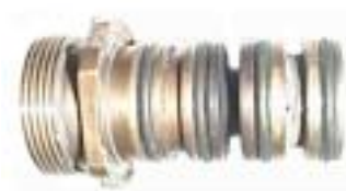
Figura 3.10 Sifón de Gases (T-14)
