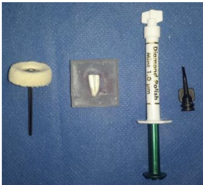
Figura 13. Muestra pulida con pasta de pulido y disco de fieltro
