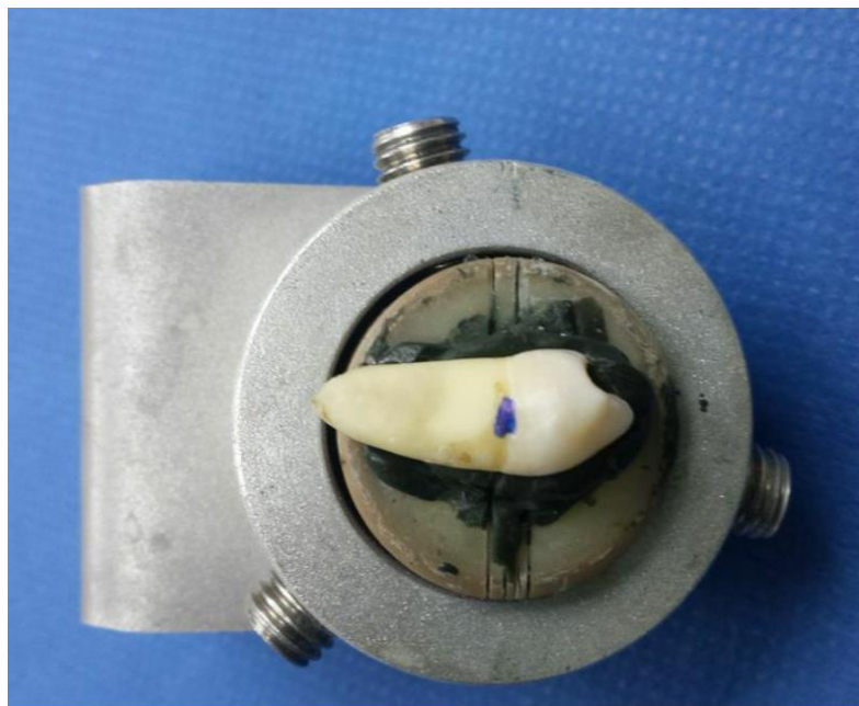
Figura 6. Colocación de las muestras en la máquina de corte
