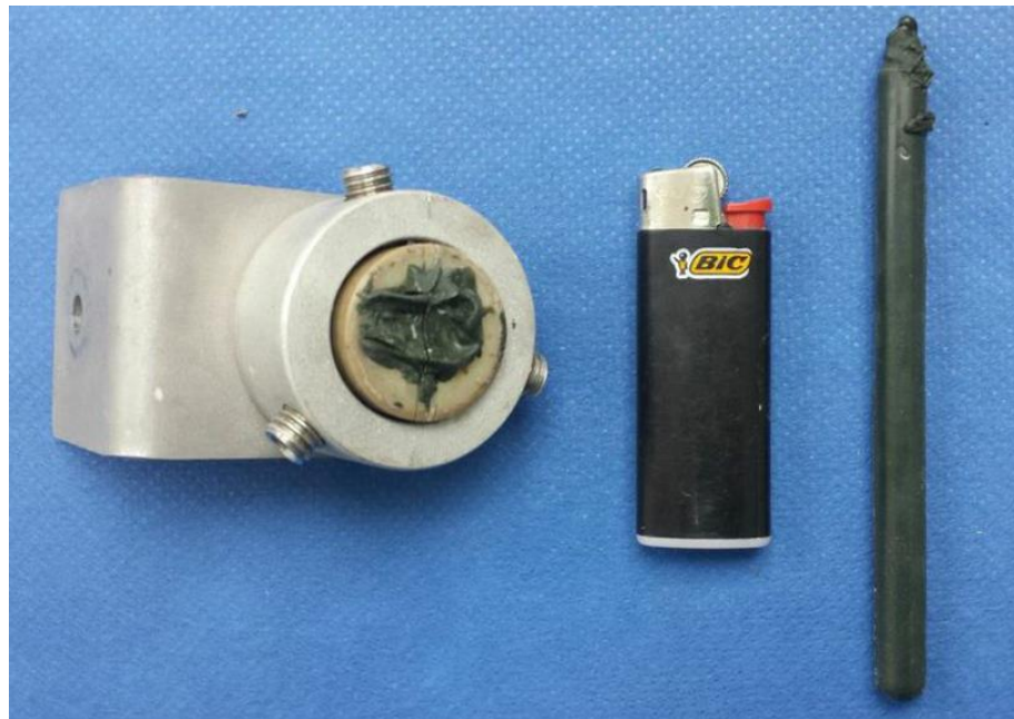
Figura 6. Colocación de las muestras en la máquina de corte
