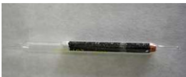
Fig. 1. Tubo de carbón activado
