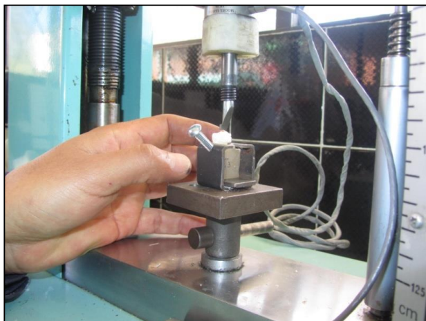
Figura 40. Colocación del espécimen en las mordazas de la máquina MTS. Fuente: Elaboración propia.
