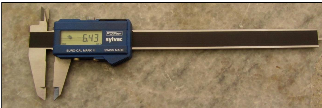
Figura 49. Calibrador digital para medición de la base y altura de la malla del bracket. Fuente: Elaboración propia.
