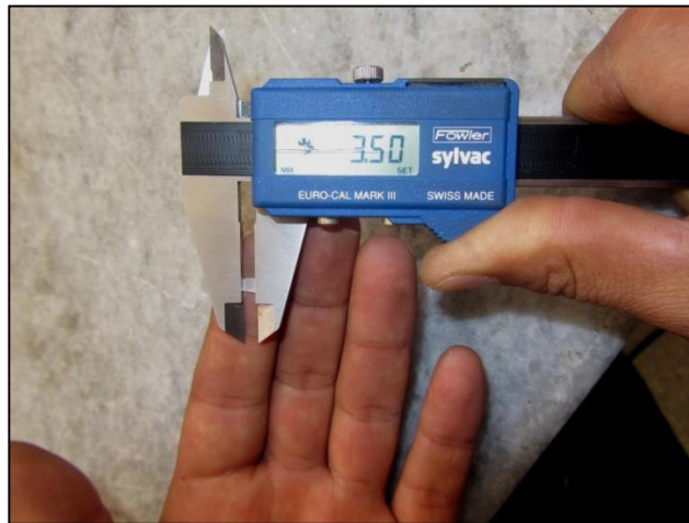
Figura 39. Medición de la base (b) y la altura (h) de la malla de cada bracket a través de calibrador digital.
