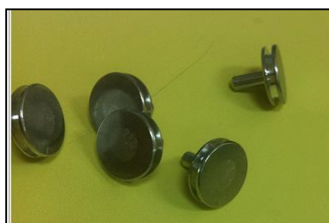
Figura 43. Portamuestras de aluminio con espiga en su base. Fuente: Elaboración propia.
