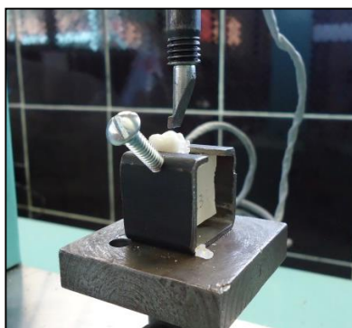
Figura 38. Cuchilla que describe un movimiento inciso-gingival a nivel de la interfase bracket-esmalte. Fuente: Elaboración propia.
