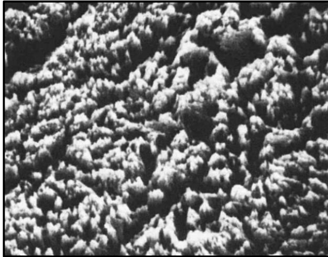
Figura 8. Patrón de grabado ácido tipo 4 después de aplicación de ácido fosfórico por 1 minuto. (Galil & Wright, 1979)
