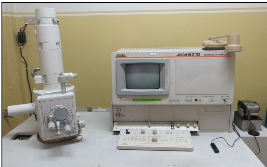
Figura 23. Microscopio Electrónico de Barrido o Scanning marca JEOL JSM 5310
