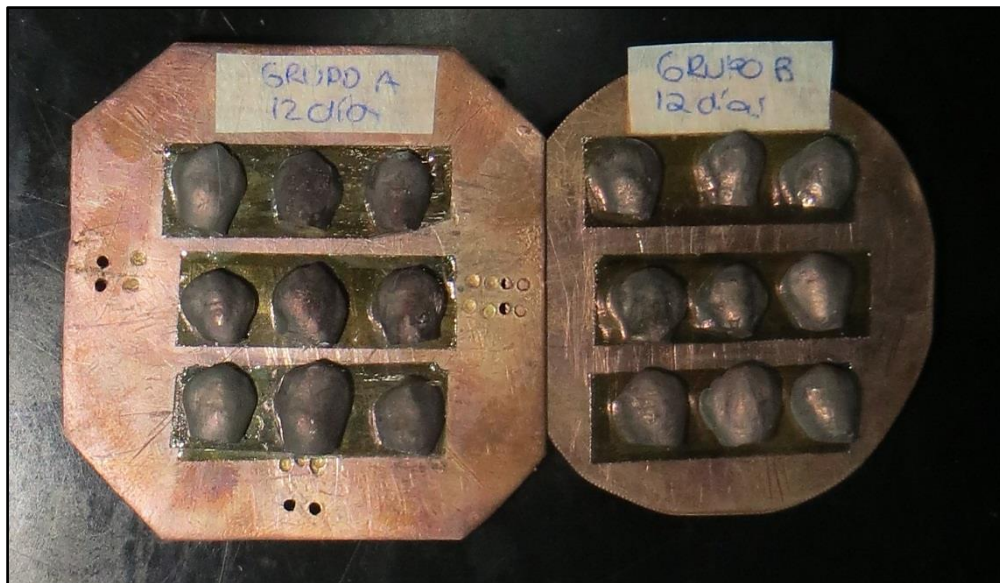
Figura 37. Grupo A y B a los 12 días de haber estado sumergidos en la solución de tratamiento, recubiertos con oro
