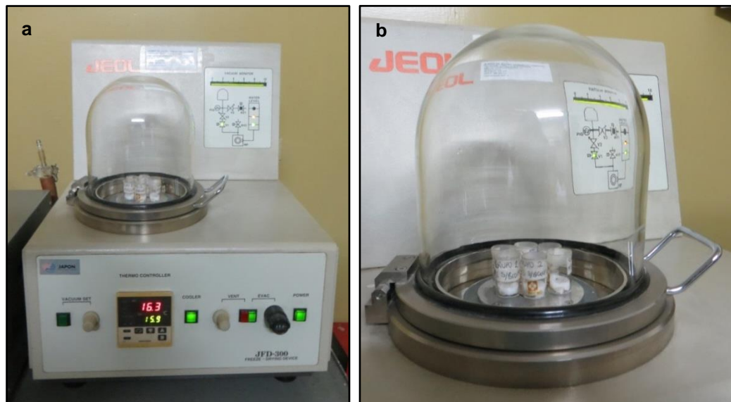
Figura 32. Secador por congelación a. Máquina de secado por congelación b. Jarra de la secadora por congelación conteniendo a las muestras
