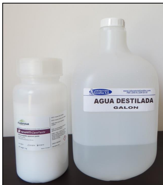
Figura 19. nanoXIM•CarePaste y agua destilada para preparación de las soluciones de tratamiento al 5%, 10% y 15%
