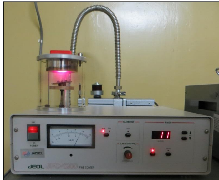
Figura 34. Recubrimiento de las muestras con oro
