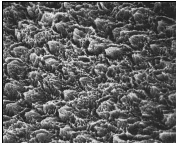
Figura 6. Patrón de grabado ácido tipo 2 después de aplicación de ácido fosfórico por 1 minuto (Galil & Wright, 1979)
