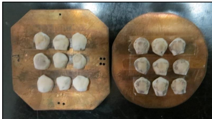
Figura 33. Montaje de las muestras en placa de cobre
