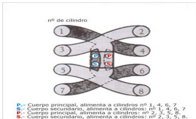
Ilustración 26. Esquema de un colector de admisión para un motor de 8 cilindros en v, alimentado por un carburador cuádruple (Durán, 2010)
