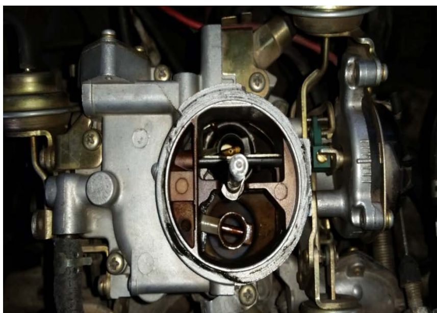
Ilustración 42. Carburador original Suzuki Forsa, de doble Venturi y difusor (el autor, 2015).
