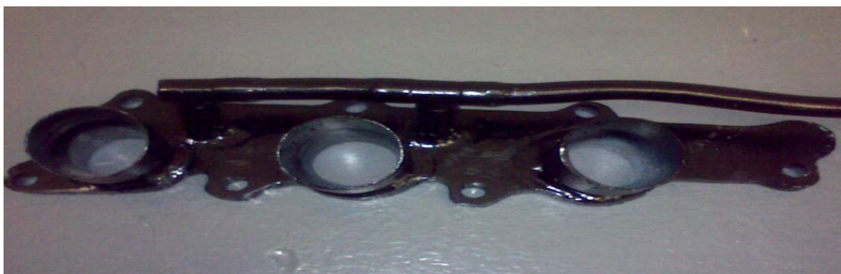
Ilustración 49. Colector de admisión tipo weber terminado (el autor, 2015).
