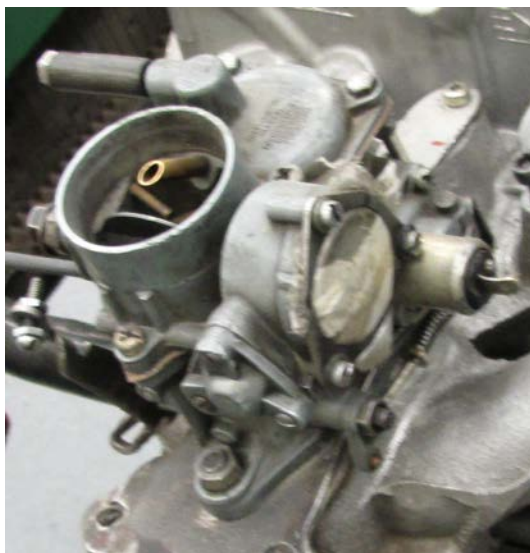
Ilustración 41. Carburador de difusor fijo, y múltiple de admisión para un solo carburador (el autor, 2014)
