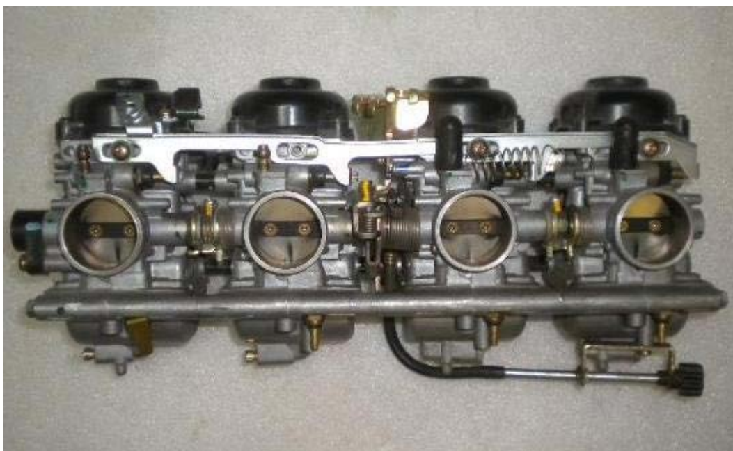
Ilustración 47. Cuatro carburadores (de difusor y Venturi variable) de motocicleta individuales, (Motosvan, 2012).
