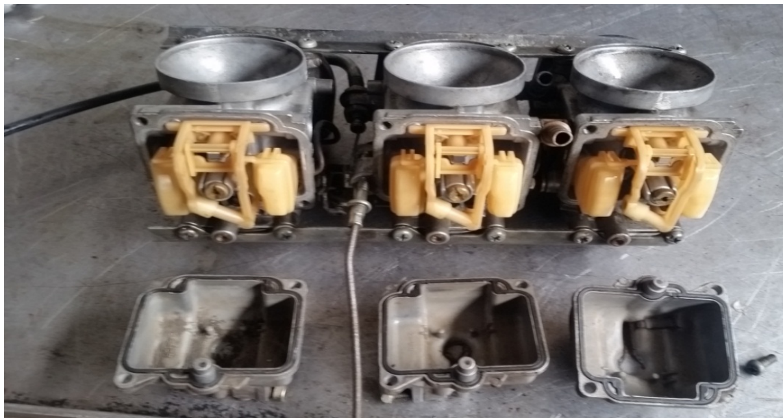
Ilustración 56. Carburadores desarmados la cuba, para limpiar los ductos y gicleur (el autor, 2015)
