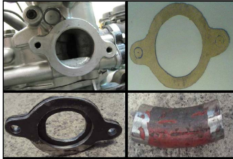
Ilustración 39. Diseño y fabricación de codo de ingreso de líquido refrigerante hacia el cabezote (el autor, 2015)
