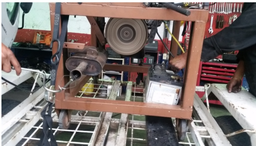
Ilustración 64. Sonda lambda midiendo los gases de escape de la maqueta (el autor, 2015)
