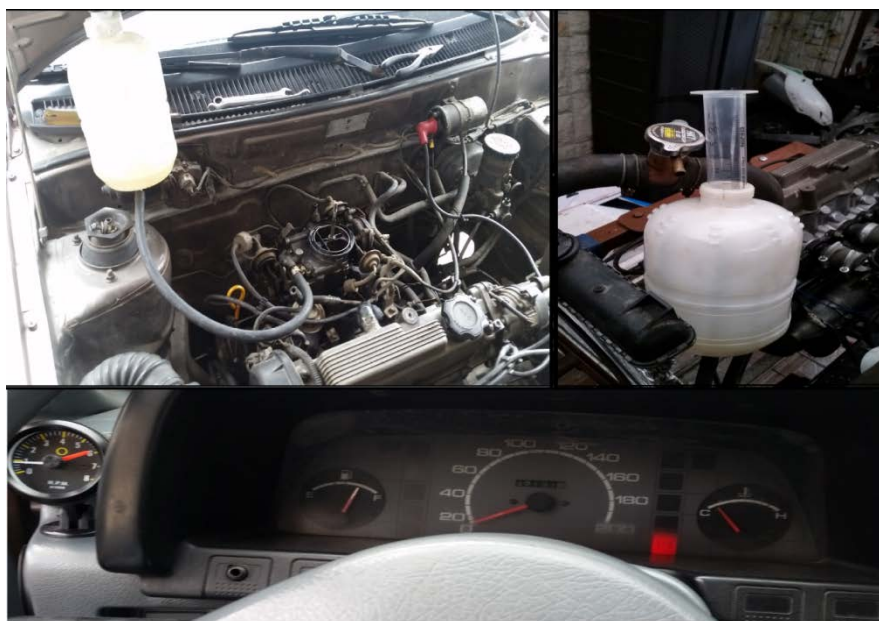
Ilustración 65. Comparación de consumo de combustible al mismo régimen de RPM en un motor estándar versus el motor trucado (el autor, 2015)
