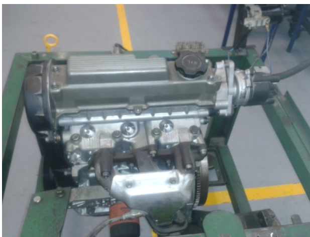
Ilustración 38. Motor Suzuki Forssa con sistema de refrigeración faltante (el autor, 2014)
