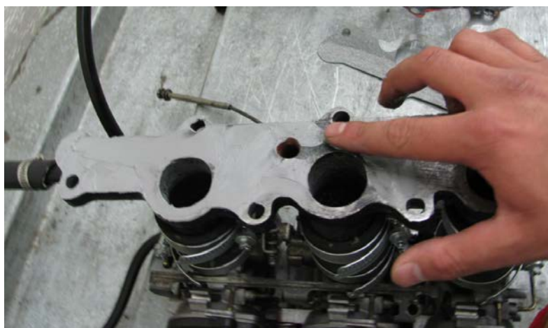
Ilustración 55. Colector de admisión con silicón y empaque de amianto (el autor, 2015)
