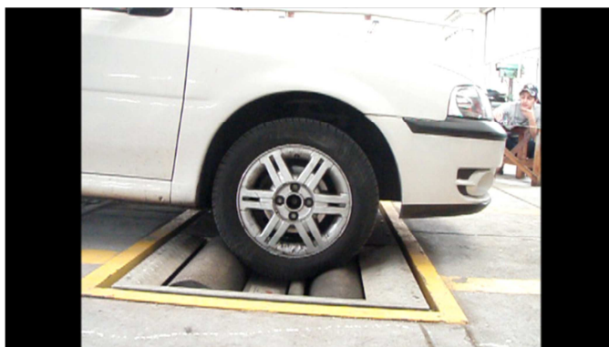
Ilustración 33 Medición en banco de rodillos (Velasteguí, 2014)
