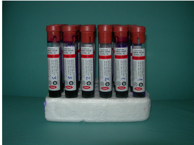
Figura 21. Tinción de los cuerpos de prueba con violeta de genciana y colocados en Incubadora por 24 horas
