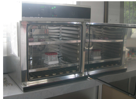
Figura 18. Cuerpos de prueba sometidos a termociclado
