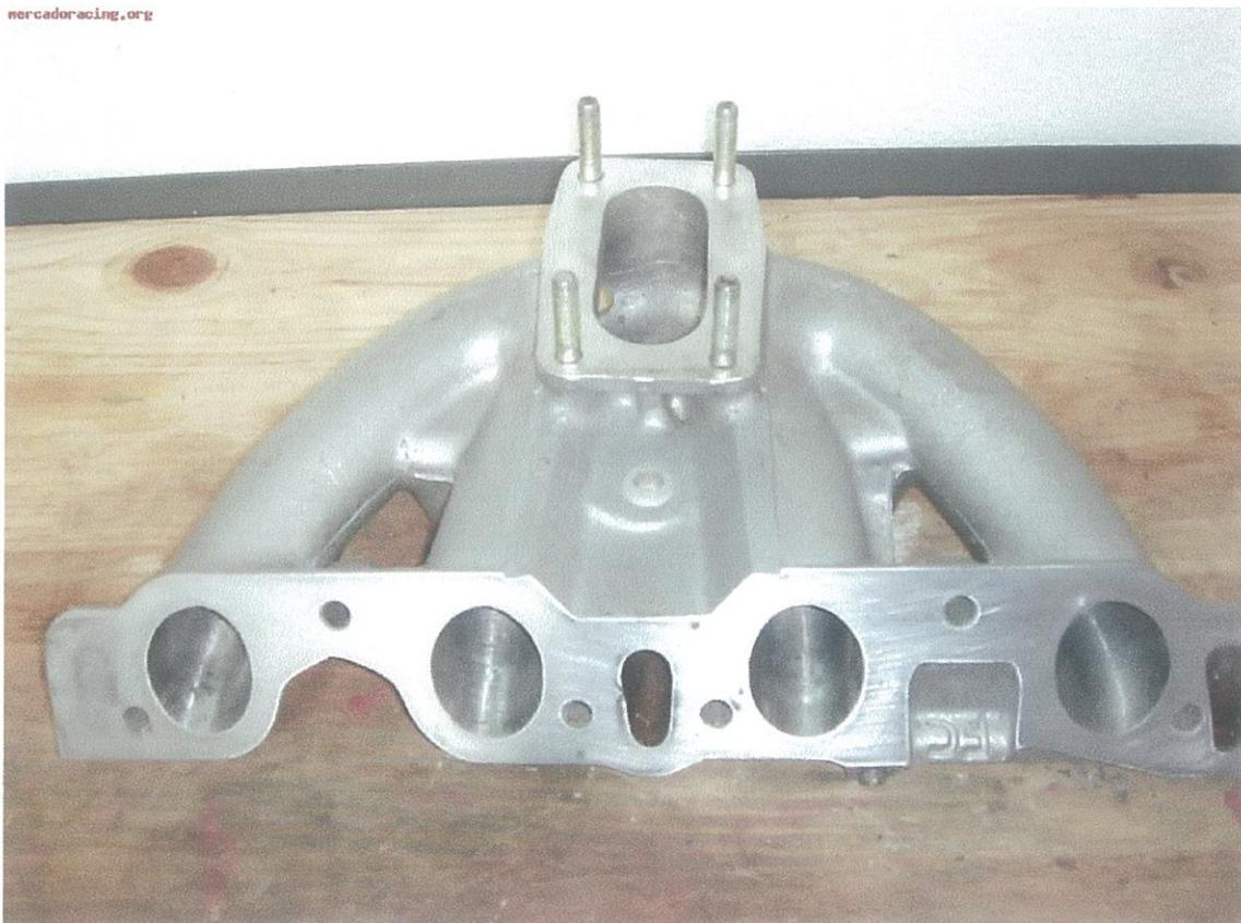
Fig. 2.3 Colector de admisión
