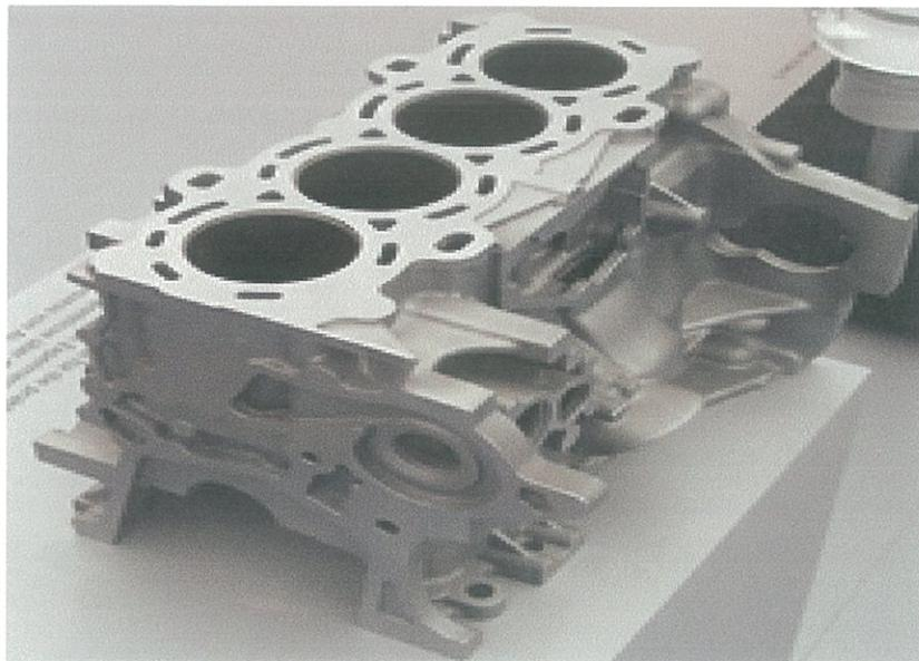
Fig.2.1 Bloque de un motor en línea
