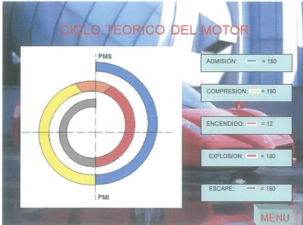
Fig. 1.2 Diagrama de válvulas ciclo teórico
