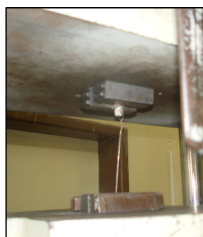
Figura 97. A y B Colocación de las muestras en las mordazas de la máquina universal de fuerzas.
