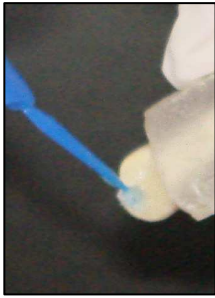
Figura 79. Aplicación de silano sobre la resina
