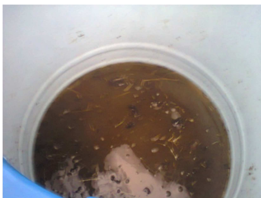
Figura 4.3 Combinación agua-estiércol 1,6 : 1 en tanque de premezcla
