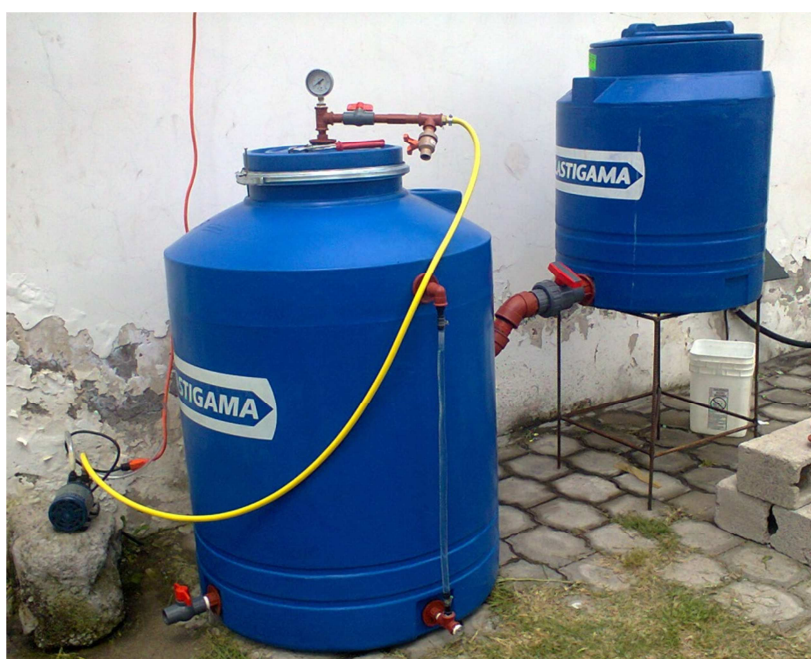
Figura 3.19 Pruebas de hermeticidad con pequeña bomba de aire de baja presión
