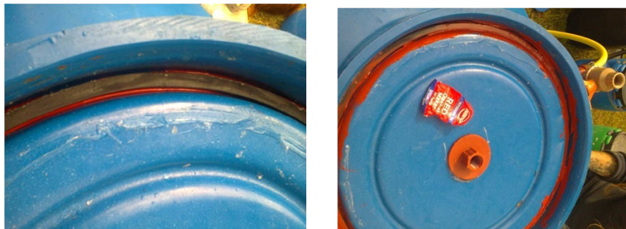
Figura 3.16 Capa de silicona por debajo y por encima del empaque de la tapa
