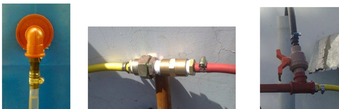
Figura 3.17 Fijación de distintas mangueras a acoples con abrazaderas metálicas
