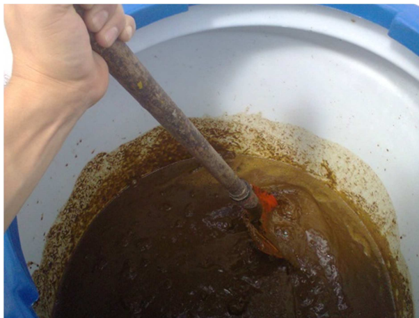
Figura 4.4 Mezcla para eliminación de sólidos y dilución del sustrato
