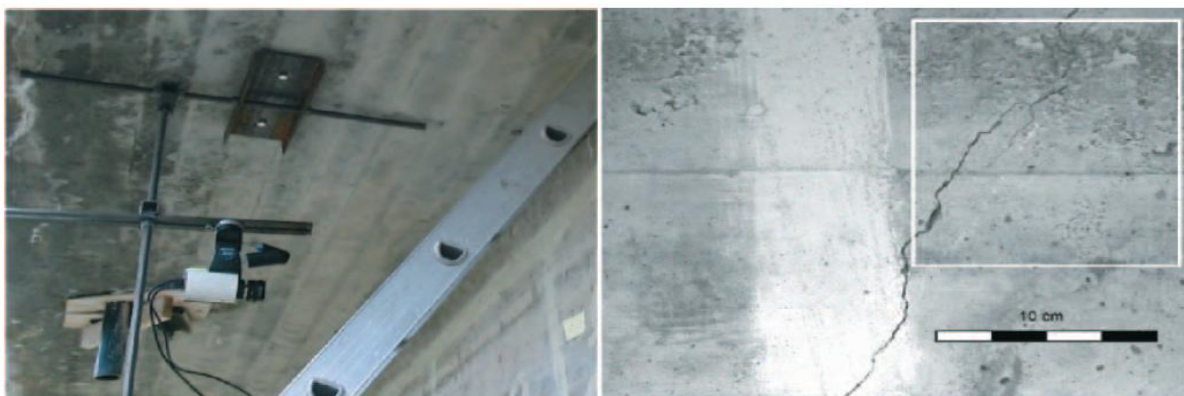
Figura 2: Ensayo de carga y descarga en la viga de un puente. (Michel Küntz et al., 2006).
