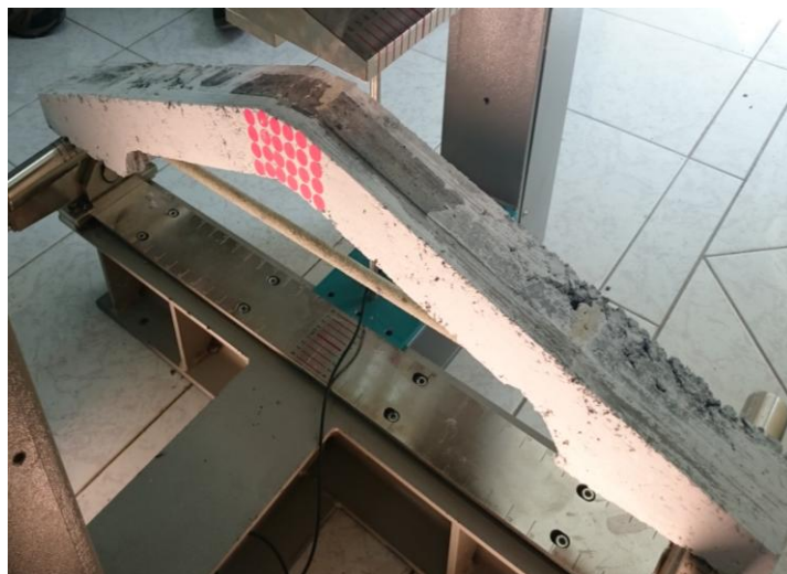
Figura 14: Montaje de los arcos de hormigón armado
