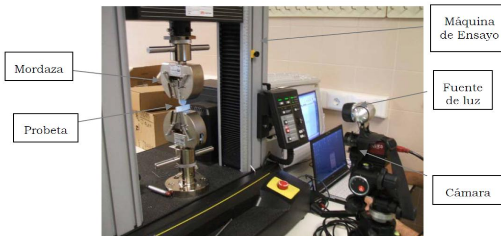
Figura 1: Montaje de los equipos. E. López-Alba et al., 2010
