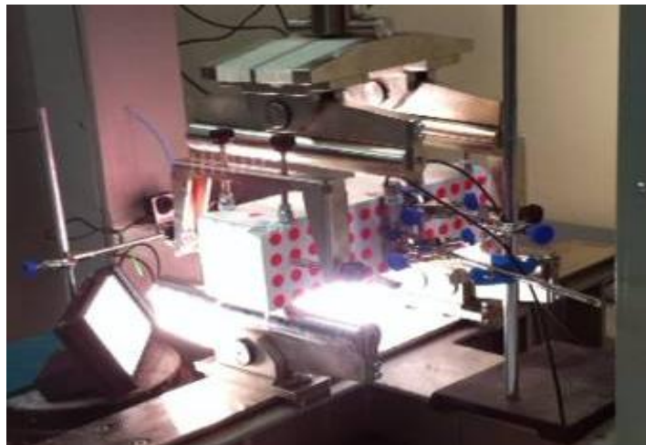
Figura 13: Montaje de las vigas de hormigón del estudio con todos los equipos
