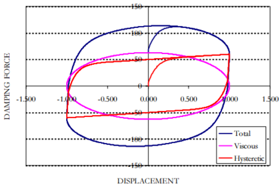
Figura10: Amortiguador histerético en paralelo con amortiguador viscoso.
