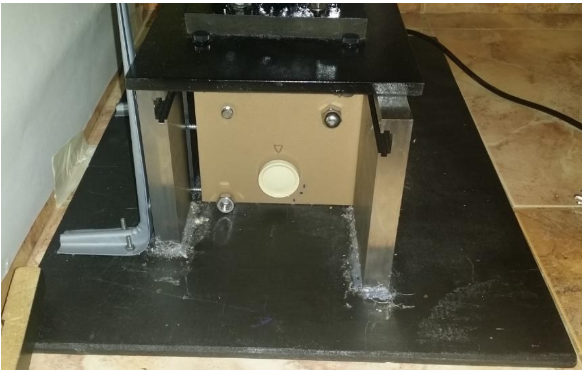
Fig. 2: Vista lateral de la mesa de excitación dinámica, en donde se muestra el temporizador que enciende el motor y regula su intensidad.
