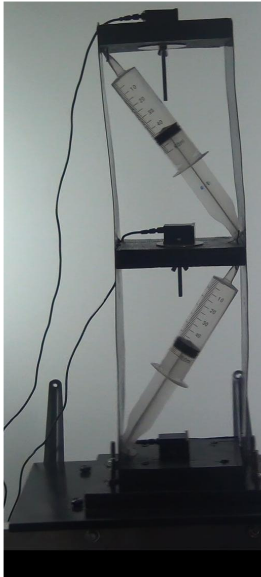
Figura19: Modelo de 2 grados de libertad empotrado en la mesa de excitación dinámica, implementado los acelerómetros en cada nivel de la estructura y amortiguadores viscosos tipo jeringa 60ml.
