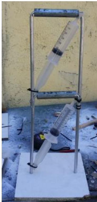
Figura 2: Segundo modelo estructural construido de 2GL.
