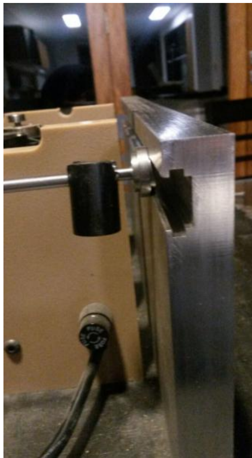
Fig. 4: Carriles de Acero en donde se asienta la base móvil, y por ende el modelo estructural a escala.
