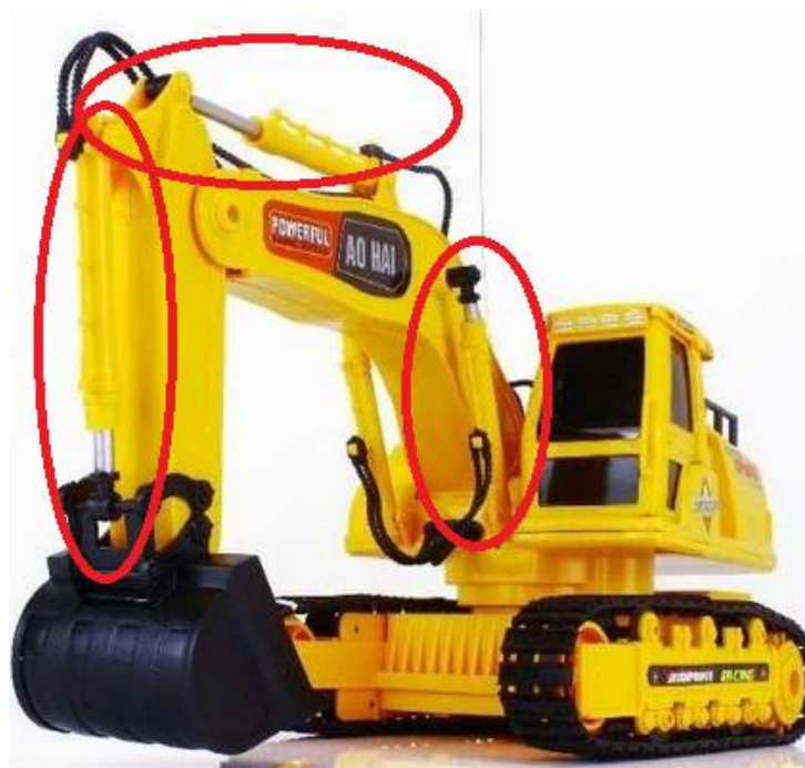
Fig. 2: Amortiguadores viscosos implementados en grúas de juguete que trabajan ante fuerzas mínimas.
