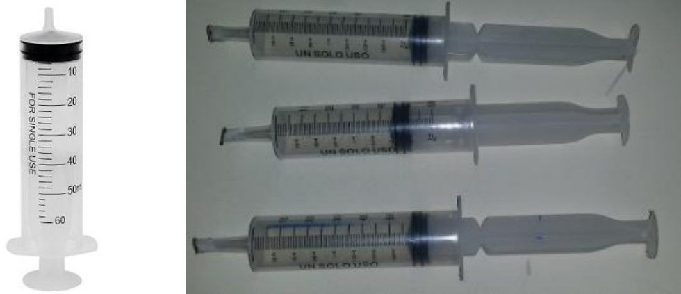
Fig. 4: a) Jeringa de 60ml b) Jeringas de 60ml selladas herméticamente para ser utilizadas como amortiguadores viscosos.
