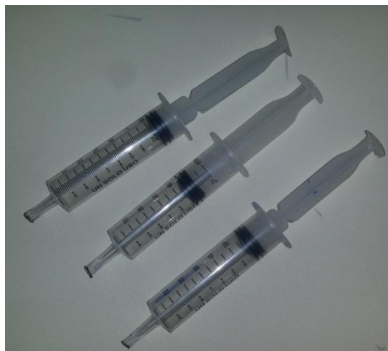
Figura 11: Jeringas de 60ml utilizadas como sistemas de disipación pasiva de energía.
