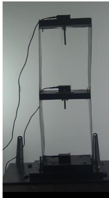
Figura 16: Modelo de 2 grados de libertad empotrado en la mesa de excitación dinámica, implementado los acelerómetros en cada nivel de la estructura.
