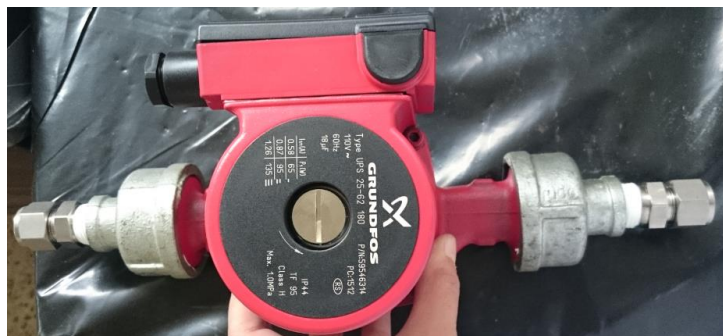
Figura 4.2: Bomba centrífuga marca GRUNDFOS
