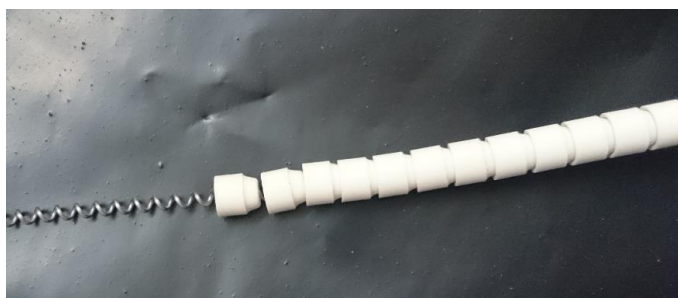
Figura 3.2: Anillos de cerámica cubriendo la niquelina
