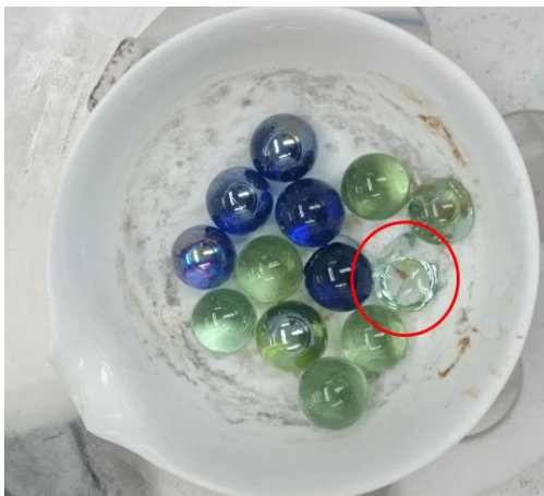
Figura 4.9: Prueba de resistencia a altas temperaturas de canicas
