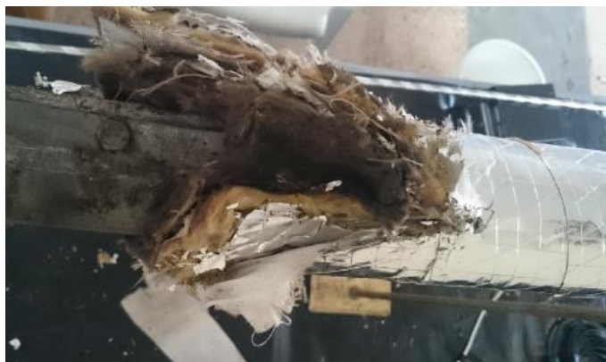
Figura 4.7: Lana de vidrio quemada por superar límites de temperatura
