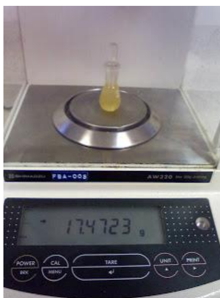
Figura 2.10: Picnómetro para medición de grados API (Roldán Viloría, 2008)
