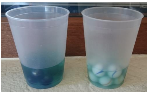
Figura 4.10: Prueba de resistencia de las canicas a hidrocarburos o gasolinas
