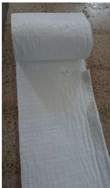
Figura 4.8: Fibra cerámica como material aislante térmico
