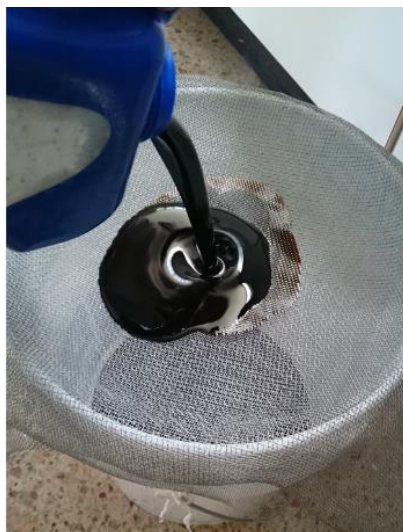
Figura 4.17: Filtración del aceite lubricante usado antes de la puesta en marcha
