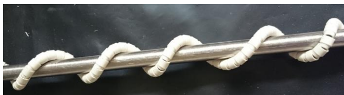
Figura 3.1: Tubo de acero inoxidable que conforma la zona de calentamiento
