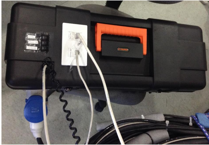
Figura 3.12-2 Bloque de Alimentación Dentro de su Contenedor
