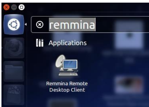
Figura 7.8: Programa Remmina para controlar el Raspberry Pi con un servidor VNC en ubuntu-linux.
