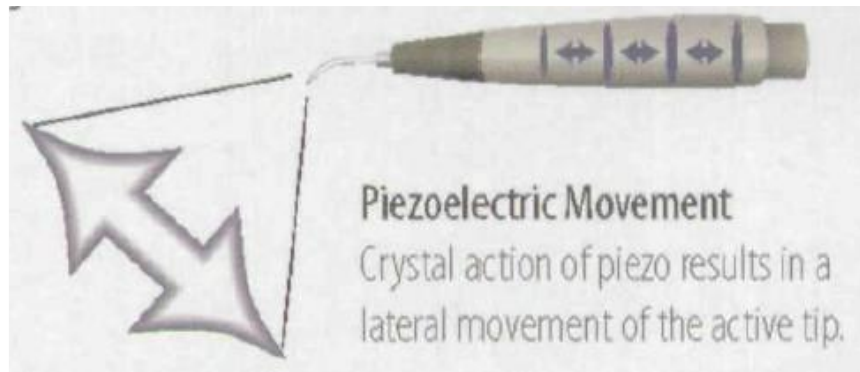
Figura.6. Dispositivo piezoeléctrico con patrón de vibración lineal Fuente: Reynolds Elizabeth, 2007
