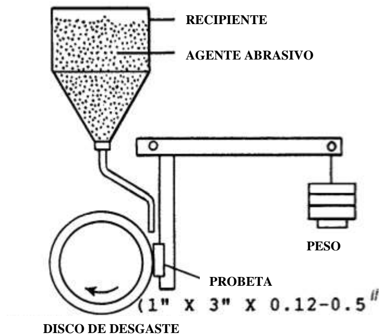
Figura 9 Esquema de la Máquina Abrasiva. ASTM G65 (ASTM, 2010)
