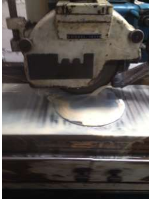
Figura 23 Rectificado tapas de disco
