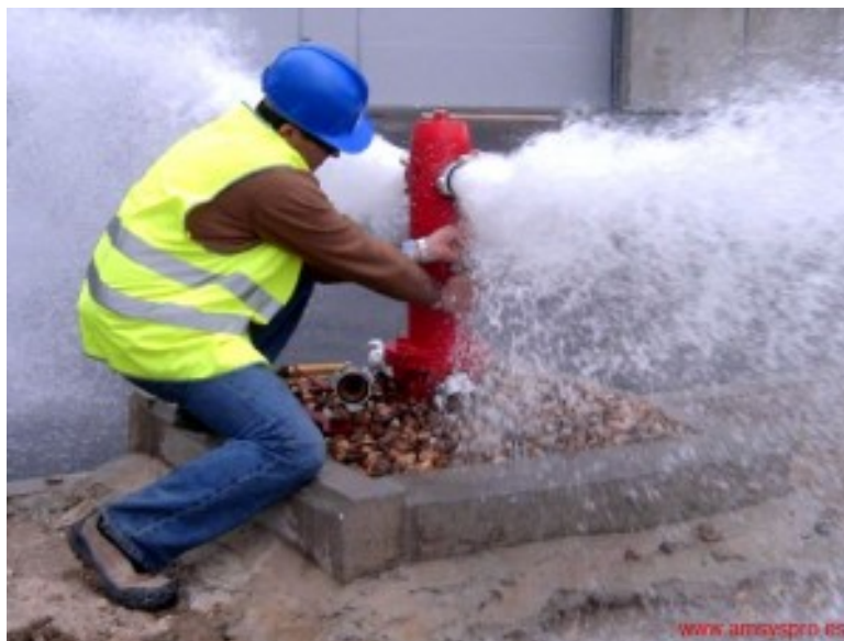
Figura 2.1. Extracción de agua de un hidrante.
