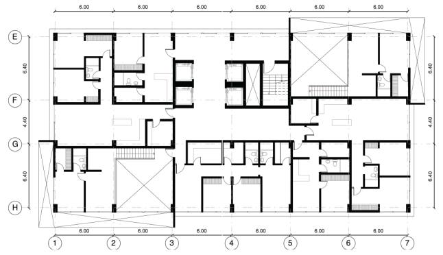
PLANTA TORRE PA ESCALA 1:250 A5'
