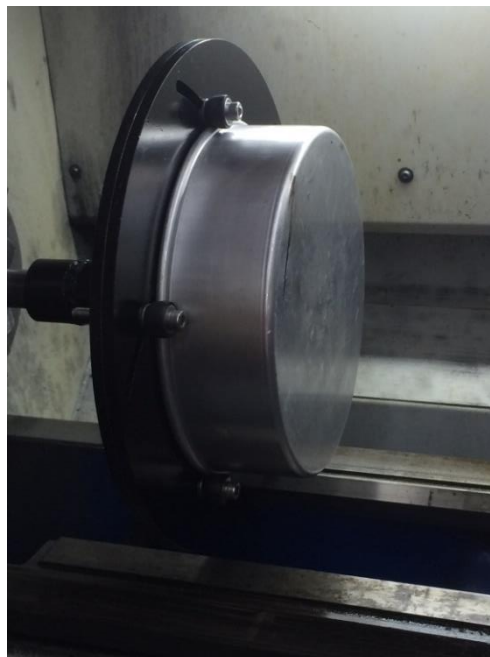
Figura 29 Prueba de sujeción de ollas mayor a 20cm de diámetro
