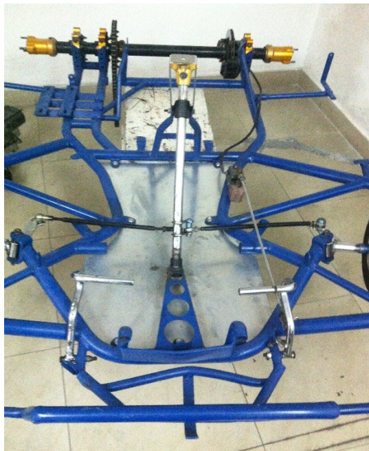
Foto Nro. 4. 9 Sistema de dirección reconstruido
