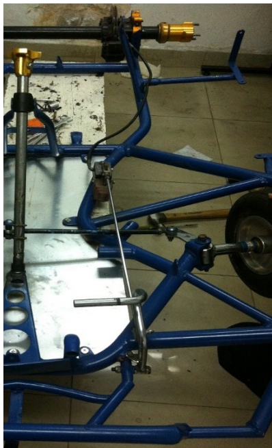
Foto Nro. 4. 10 Sistema de frenos restaurado
