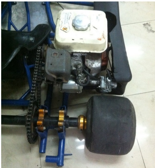
Foto Nro. 4. 12 Transmisión reparada
