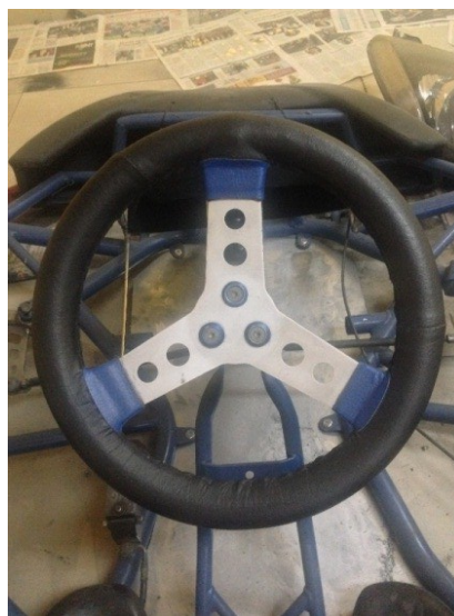
Foto Nro. 4. 7 Volante reparado
