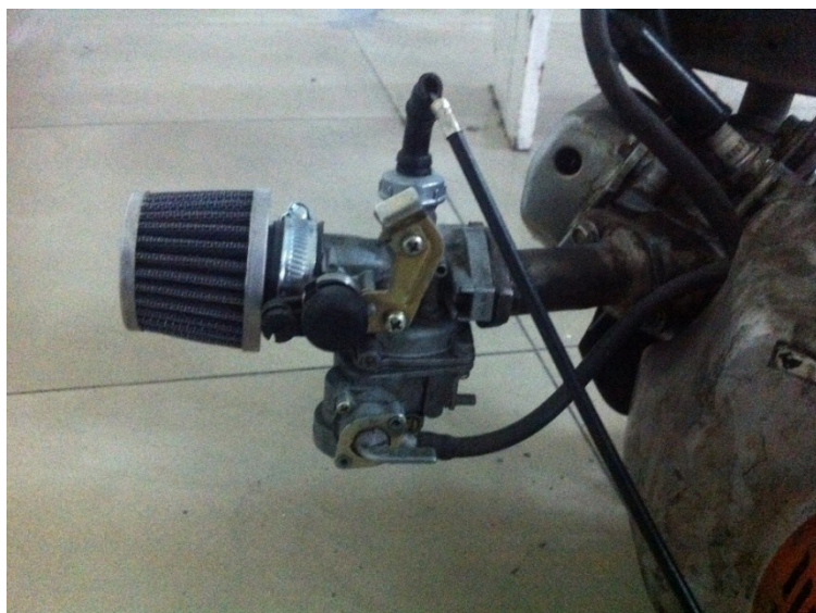
Foto Nro. 4. 18 Carburador reparado
