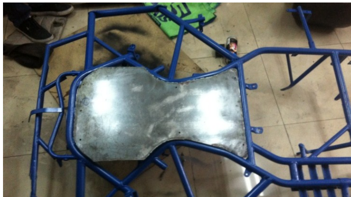
Foto Nro. 4. 2 Estructura reparada y pintada
