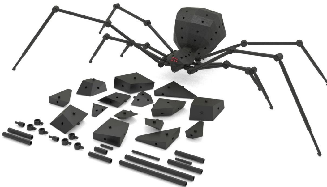
Figura 40. Visualización 3D del juguete y de las piezas que lo conforman.
