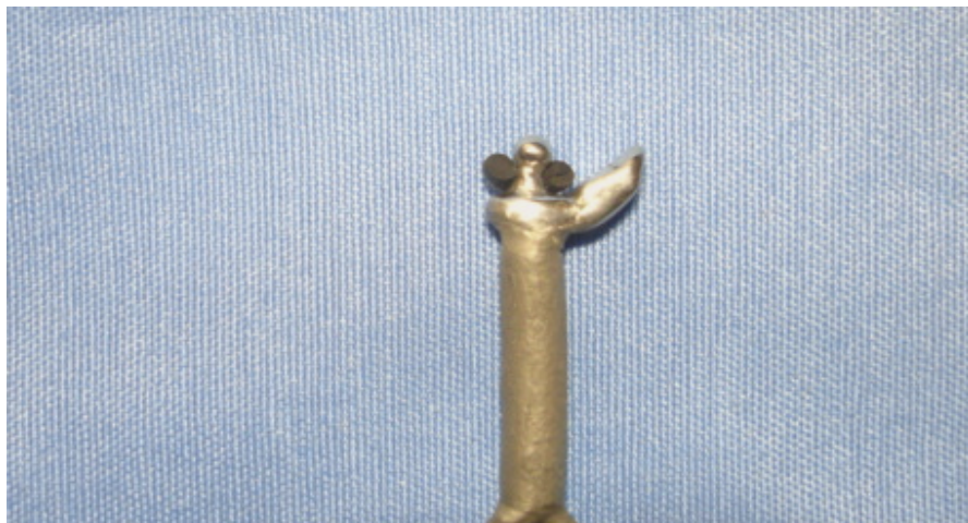
Gráfico 1: Acoplamiento de anillo de caucho en el macho
