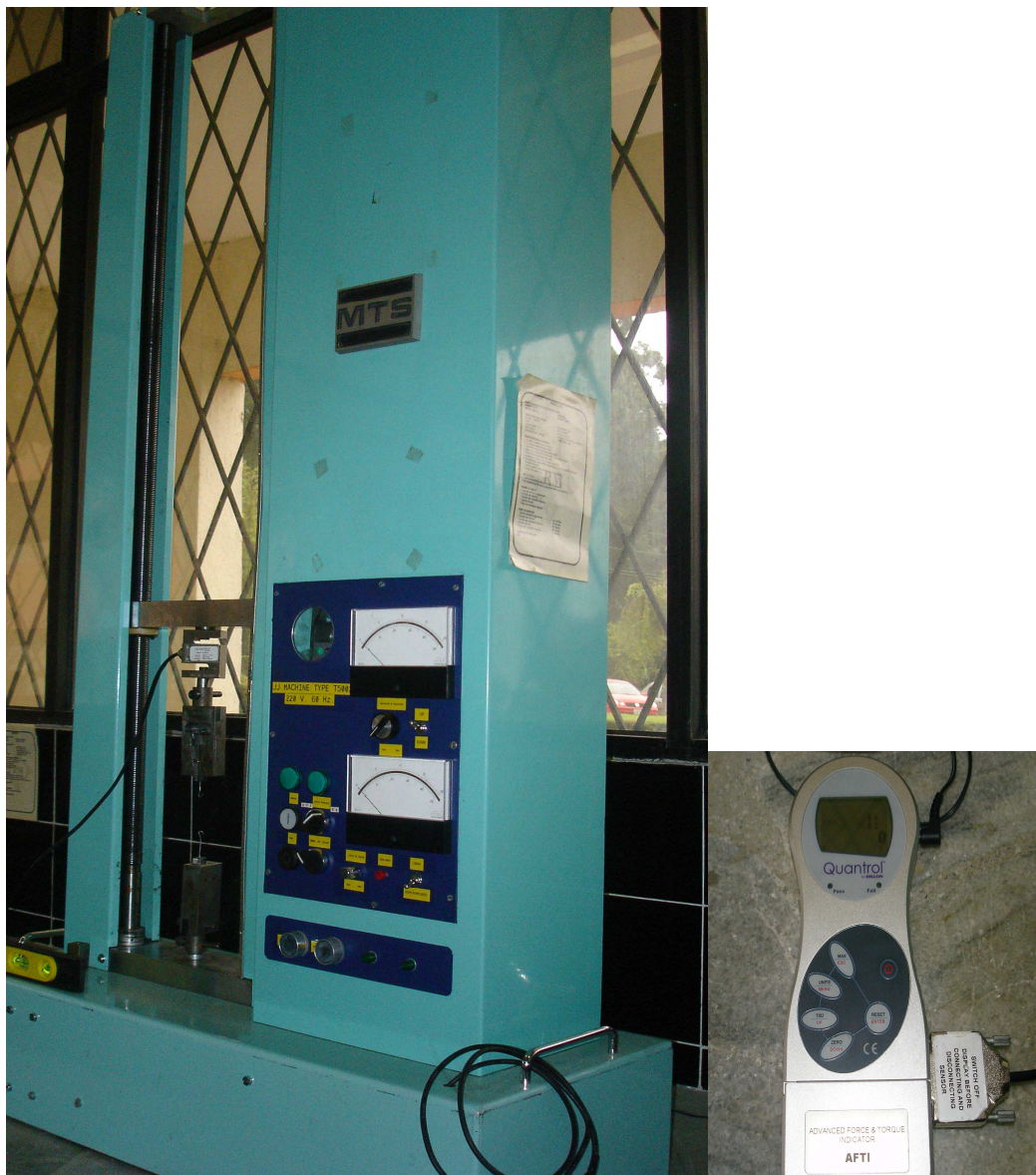
Gráfico 3: máquina MTS T5502 y Procesador Quantrol AFTI
