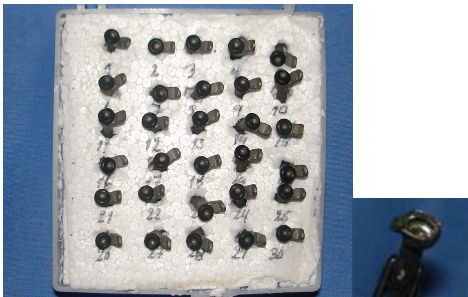
Gráfico 2: Ataches agrupados con numeración y casquete metálico para o-ring
