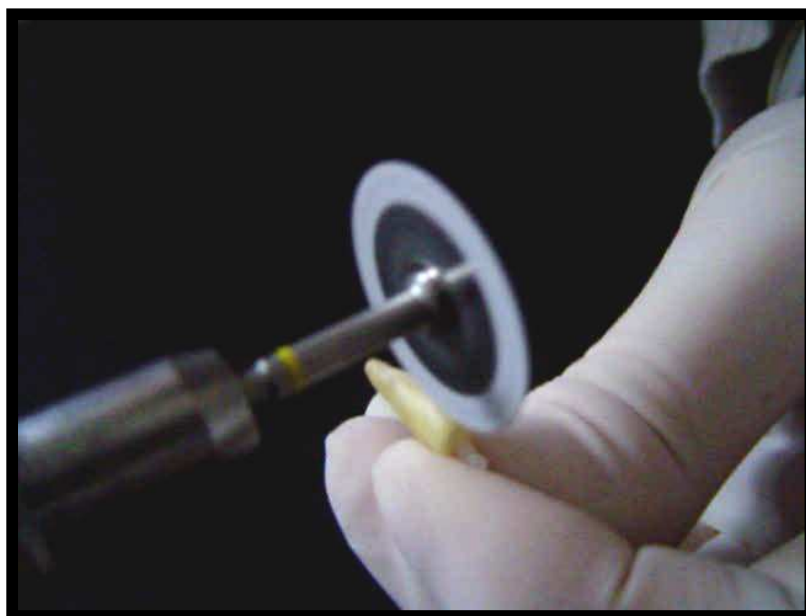
Foto 15. Corte sagital de todos los cuerpos de prueba
