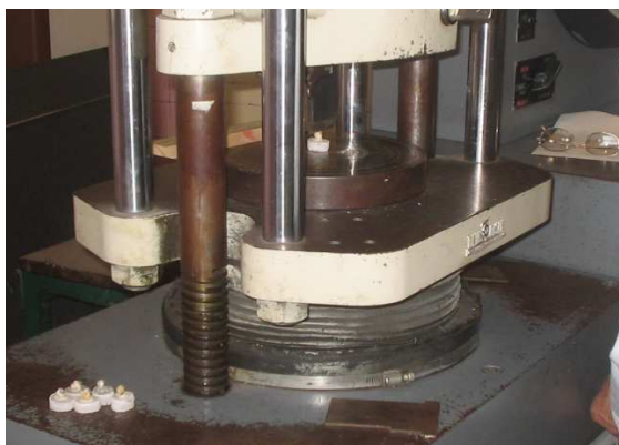
Figura 5 Maquina de pruebas universales de fuerza; vista panorámica
