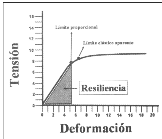
Fig. 9. Relación constante entre la tensión y la deformación. (68)
