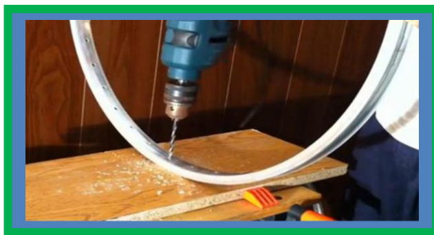
Fig.3.26 perfora el aro de la llanta
