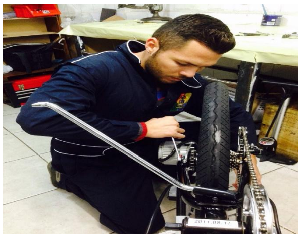
Fig. 3.13. Se saca los frenos de la llanta delantera (Terán – 2014)
