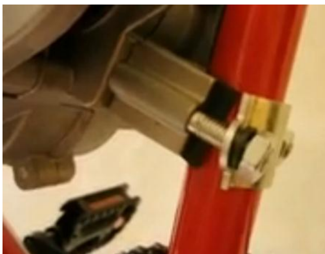
Fig. 2.18. Abrazadera de acero del montaje del motor. (Noxuz – 2013)
