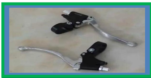
Fig. 3.14. Retirar las manillas del freno. (Teran – 2014)
