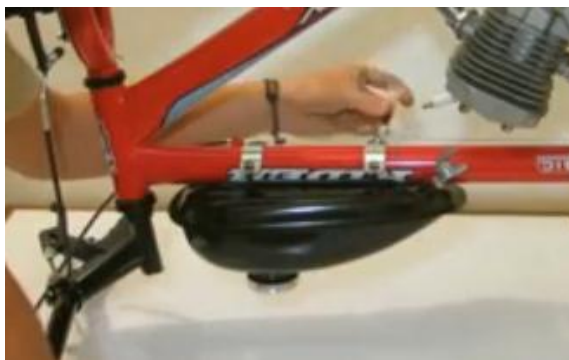
Fig. 2.24 Montaje del tanque (Noxuz – 2013)
