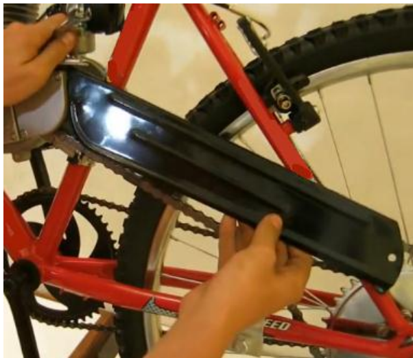
Fig. 2.32. Instalación el cubre cadena (Noxuz – 2013)
