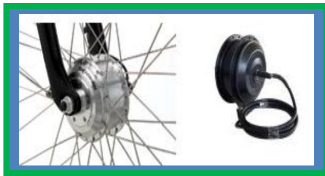
Fig. 3.5. Motor eléctrico con escobilla y sin escobilla (Freegopower – 2014)
