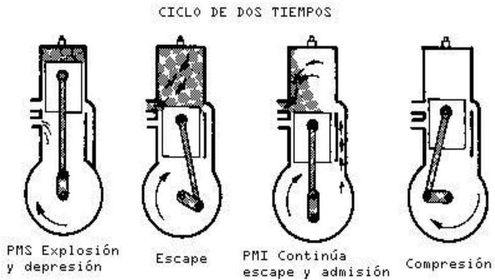
Figura 2.4. Ciclo de Motor de dos tiempos (AlMuro – 2013)
