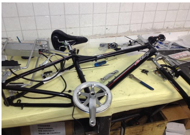
Fig. 3.16. Retiro de la llanta delantera y trasera (Terán – 2014)
