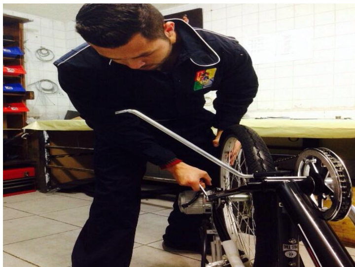
Fig. 3.17. Instalación de la rueda trasera con el motor incluido. (Terán – 2014)
