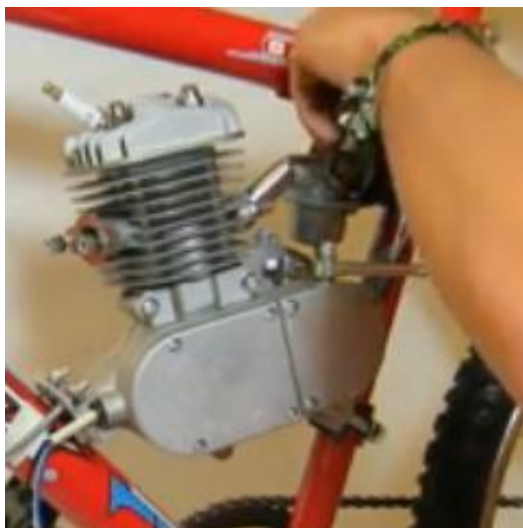
Fig. 2.20 Instalación del motor en posición horizontal (Noxuz – 2013)
