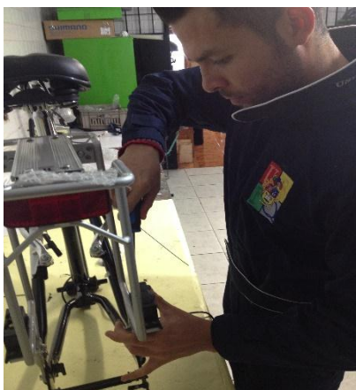
Fig. 3.12. Aflojar los frenos de la llanta posterior (Terán – 2014)
