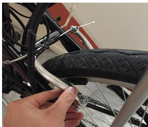
Fig. 3.21. Instalación del freno para la llanta posterior (Terán – 2014)
