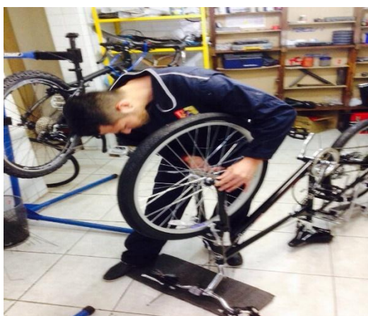
Fig. 3.20. Instalación de los frenos en la llanta delantera (Terán – 2014)
