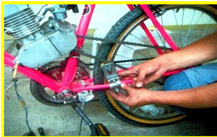
Fig. 2.9. Instalación del templador de la cadena. (Terán – 2010)
