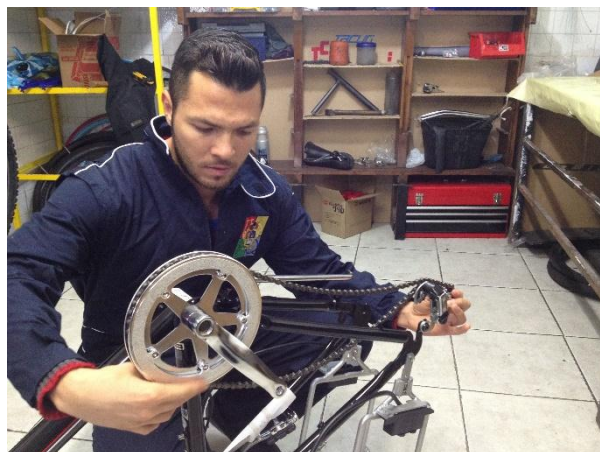
Fig. 3.22. Desinstalar el pedal (Terán – 2014)
