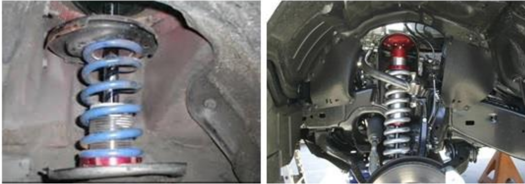
Figura 28. Proceso de instalación del coilovers izquierdo
