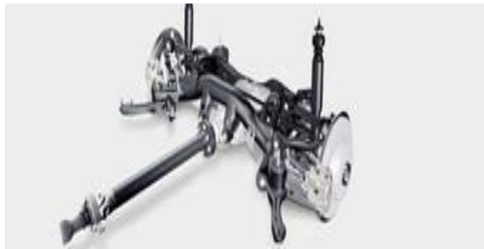
Figura 17. Sistema de suspensión multibrazo (multilink)
