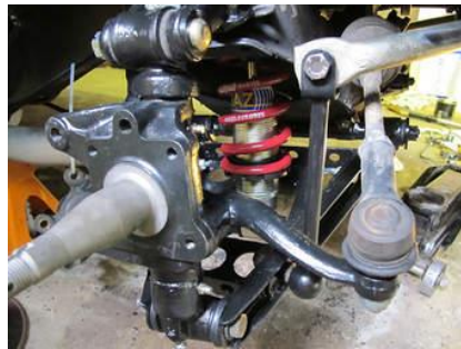
Figura 19. Sistema de suspensión delantera con coilovers
