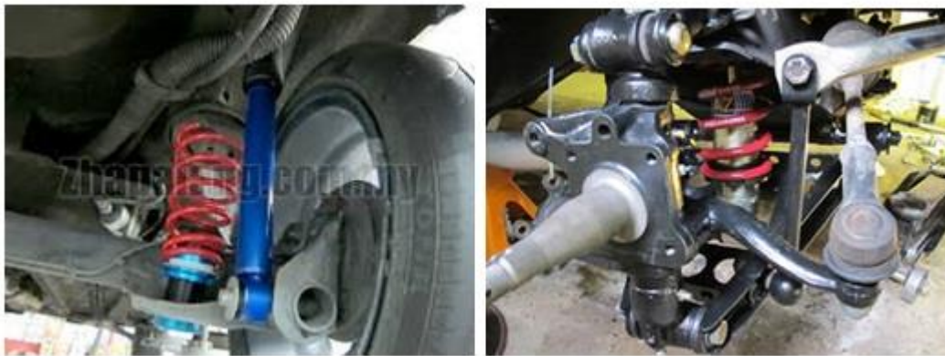
Figura 27. Proceso de instalación del coilovers derecho
