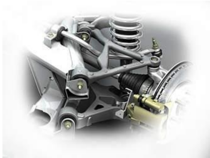
Figura 16. Sistema de suspensión de paralelogramo deformable
