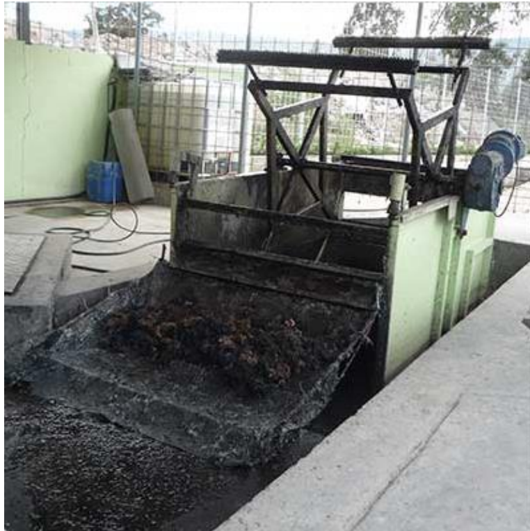
Imagen 3: Filtro de retención de sólidos para los procesos de curtido y recurtido de TSJ
