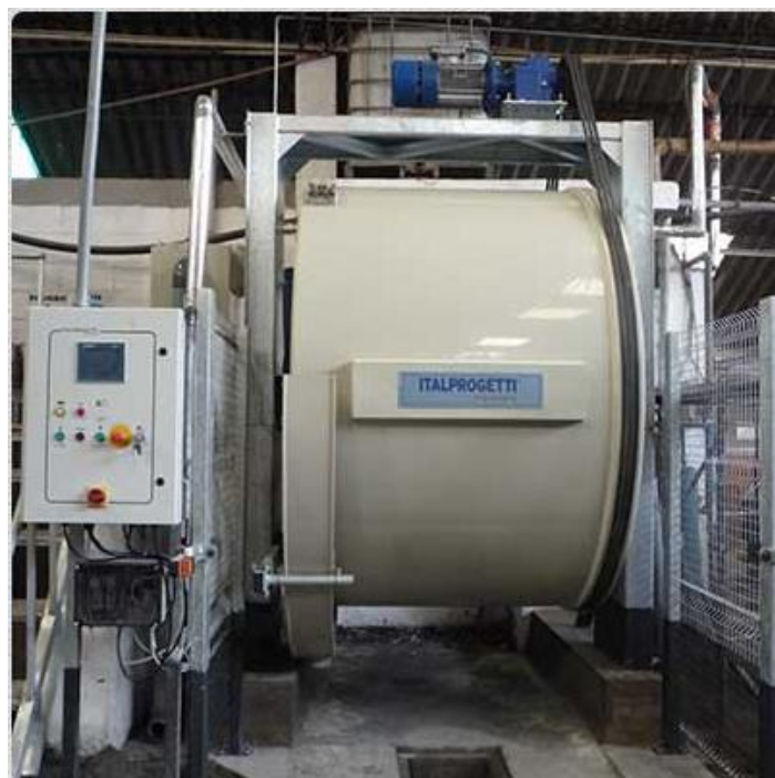
Imagen 4: Bombo de última tecnología Italprogetti con capacidad para 500Kg adquirido por TSJ
