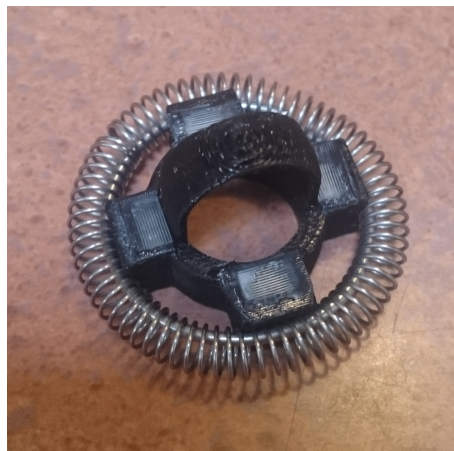
Figura 22: Agitador terminado obtenido por proceso de impresión 3D
