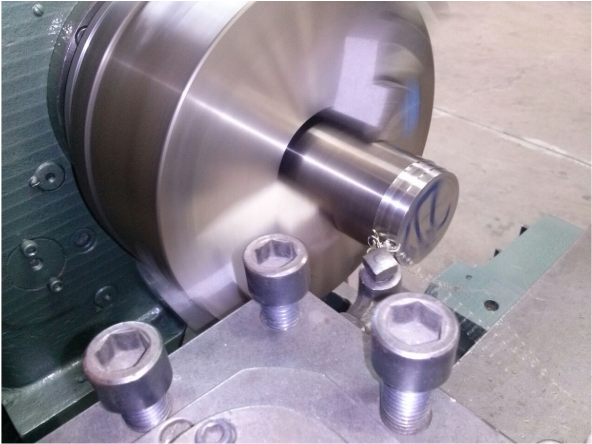
Figura 14: Torneado para el pivote de la jarra y la base en acero AISI 304
