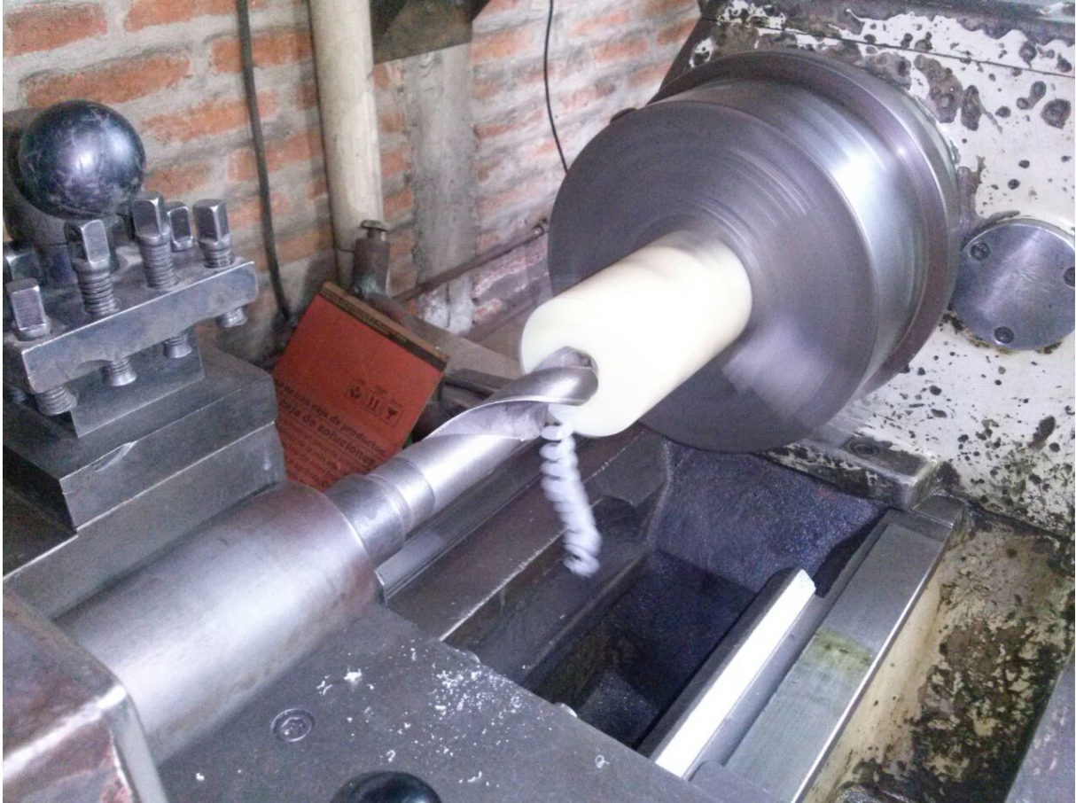
Figura 13: Torneado del soporte para el motor en duralón
