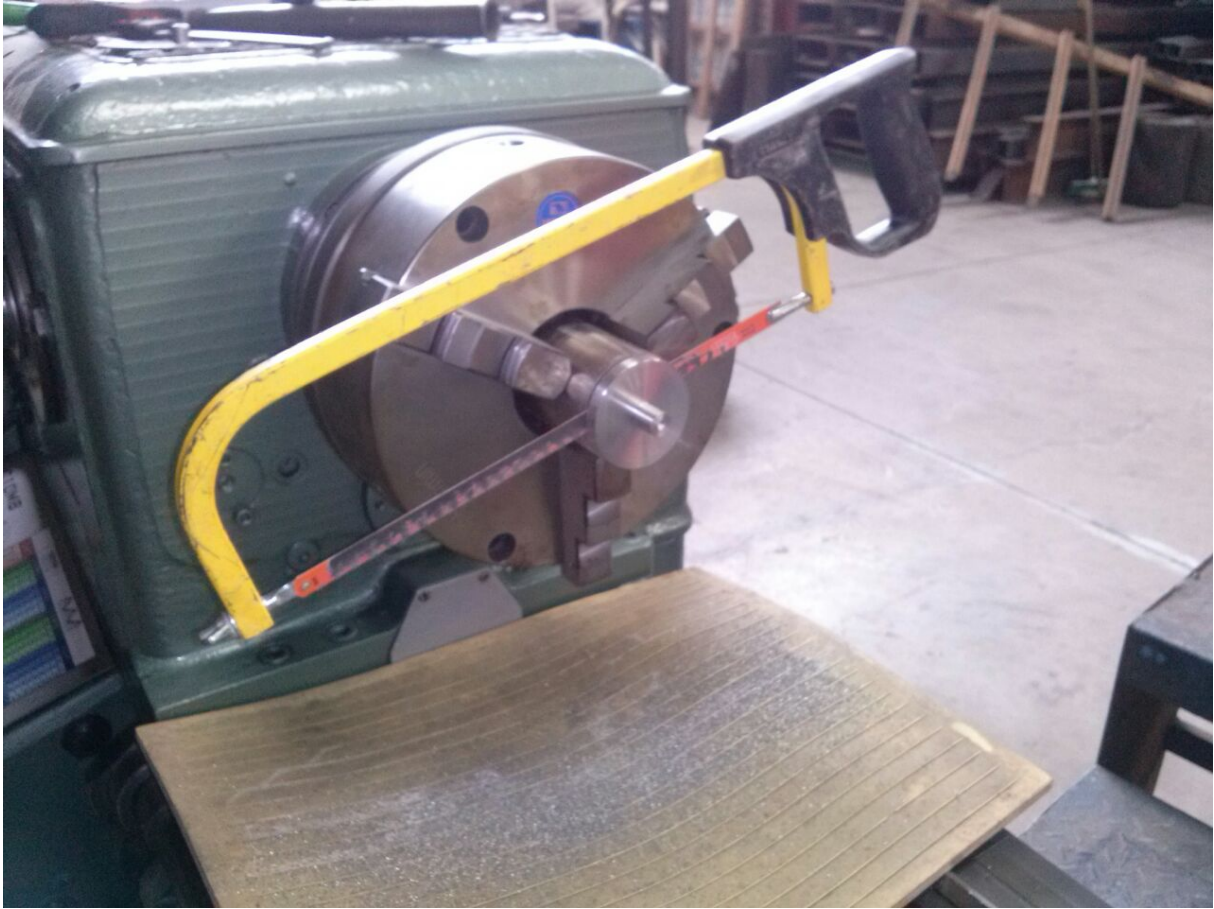
Figura 15: Corte de la pieza terminada
