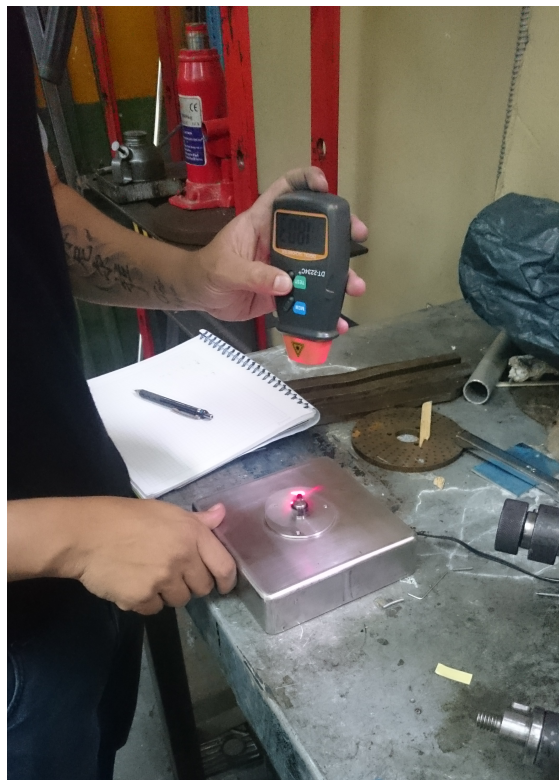
Figura 26: Medición de revoluciones con tacómetro láser
