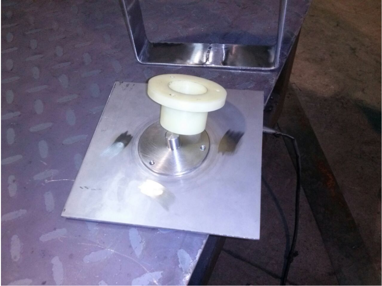
Figura 17: Soporte y pivote terminados de maquinar
