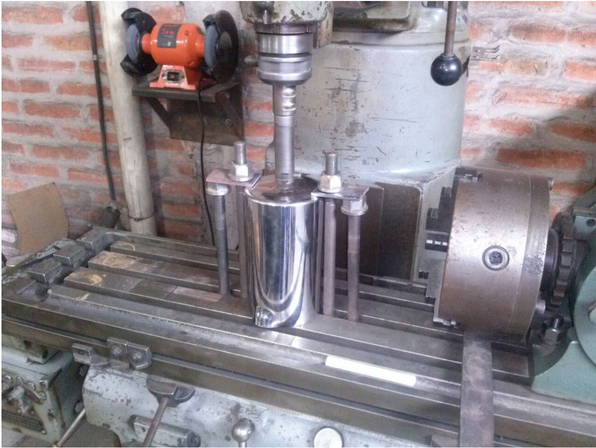
Figura 18: Fresadora realizando agujero en la jarra
